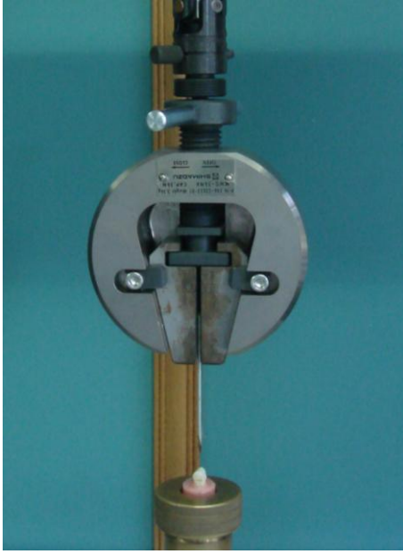
Şekil 3-18: Çalışmada kullanılan test cihazının hareketli üst parçası
