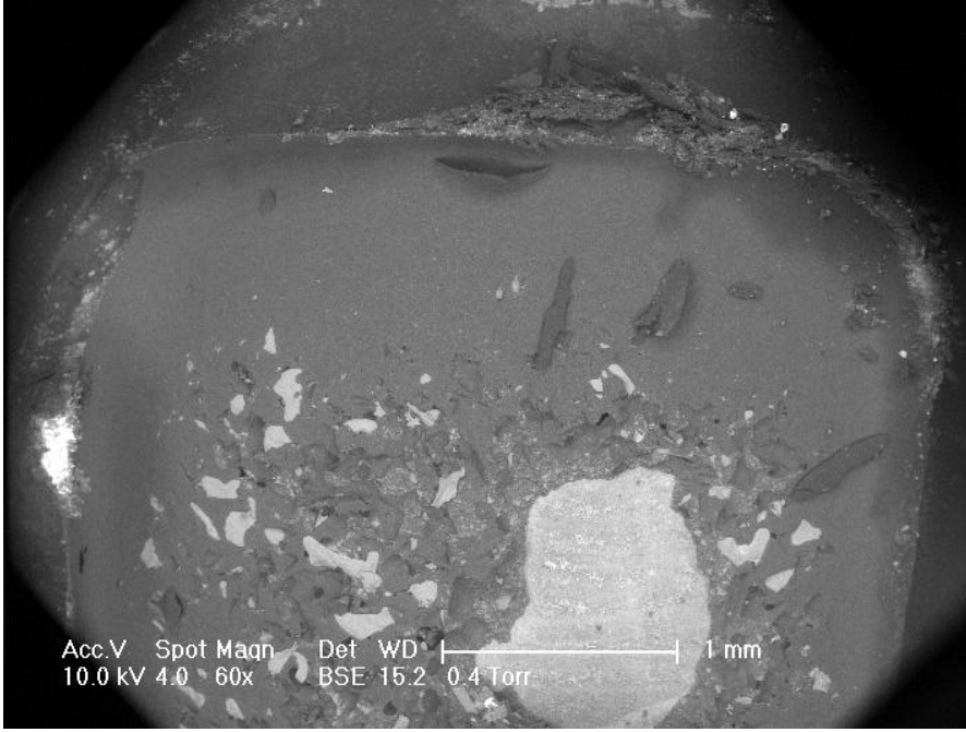
Şekil 4-6: ARI skoru 2 olan bir örneğin 60X büyütme altındaki SEM görüntüsü
