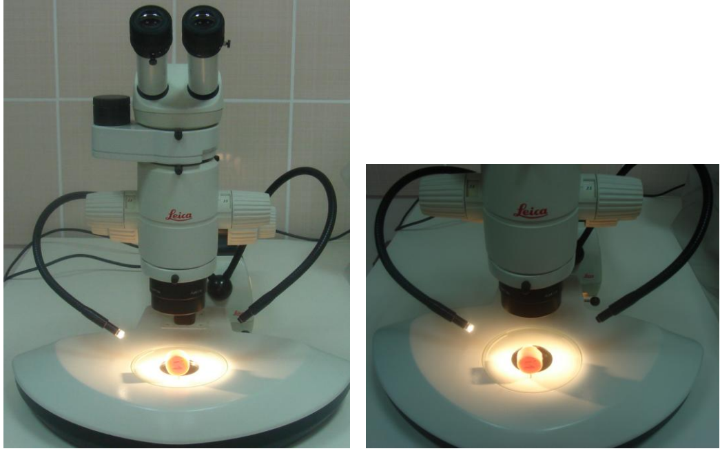
Şekil 3-19: Çalışmada kullanılan stereoışık mikroskobu
