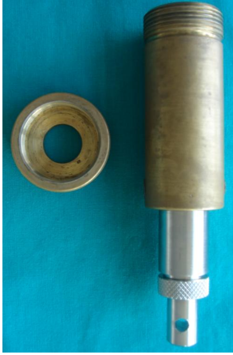
Şekil 3-26: Hazırlanan akrilik blokların kalıba alınmasını sağlayan adaptör.
