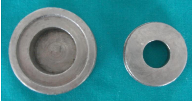
Şekil 3-23: Dişlerin akrilik bloğa alınmasında kullanılan metal kalıp
