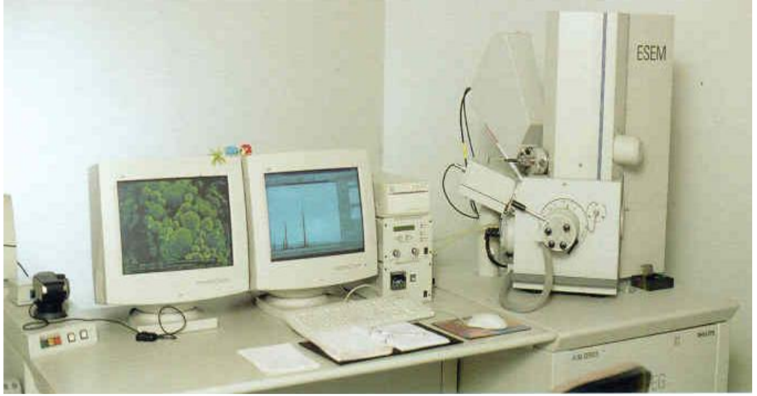
Şekil 3-20: Çalışmada kullanılan Taramalı Elektron Mikroskobu (Phillips ESEM FEG XL 30)
