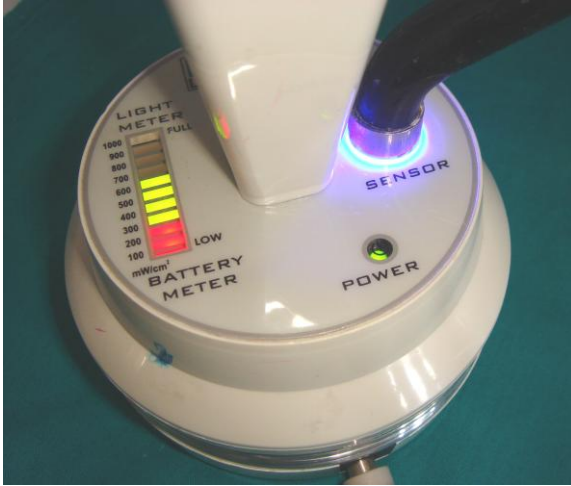
Şekil 3-16: Çalışmada kullanılan ışık cihazının yaydığı ışık yoğunluğunun ölçülmesi
