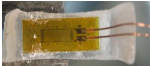
Şekil 2.3. Tek elemanlı gerinim ölçerin akrilik yapı üzerine yapıştırılması.
