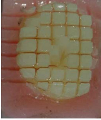
Resim 1: Yaklaşık 1x1 mm ebatlarında elde edilen çubuklar
