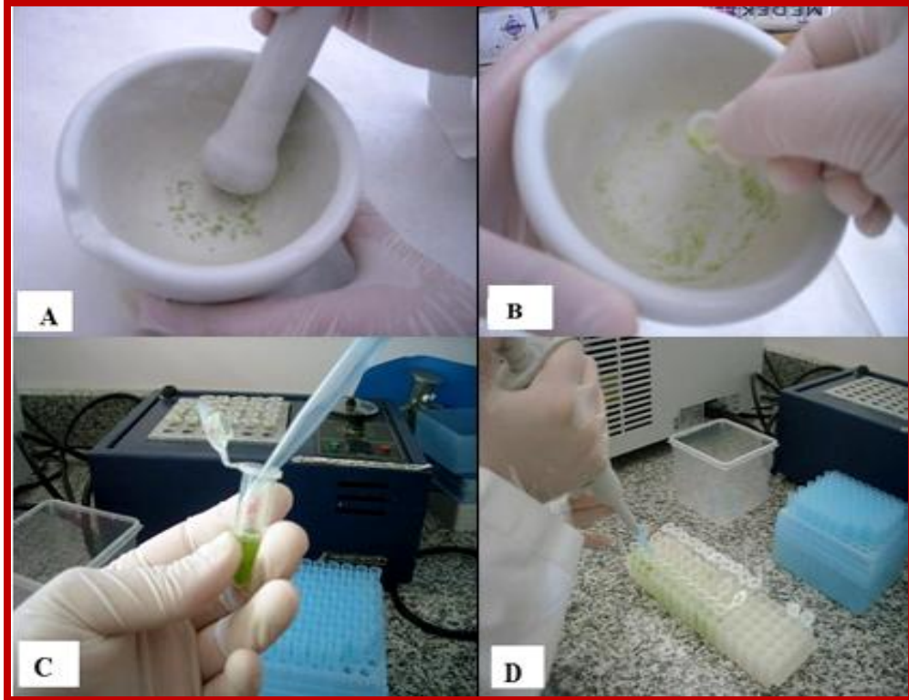
Şekil 3.6. (A)Eksplantların öğütülmesi, (B) Öğütülen eksplantların ependorf tüplerine alınması (C), (D) Ependorf tüplerdeki örneklerin üzerlerine CTAB çözeltisinin eklenmesi
