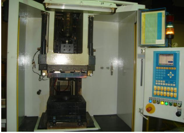
Resim 7.5. UHP püskürtme presi
