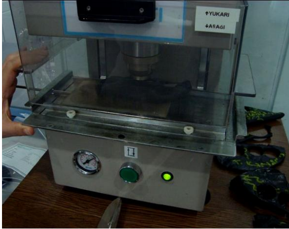
Resim 7.11. Numune kesme cihazı
