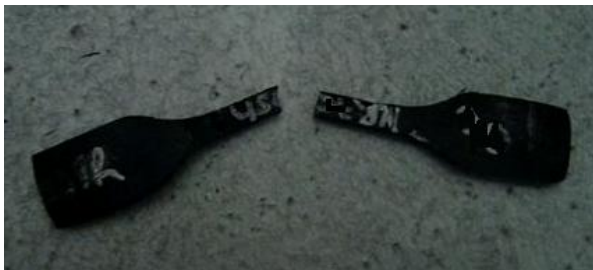
Resim 7.21. Kopma - kopma anı uzama testi numunesi
