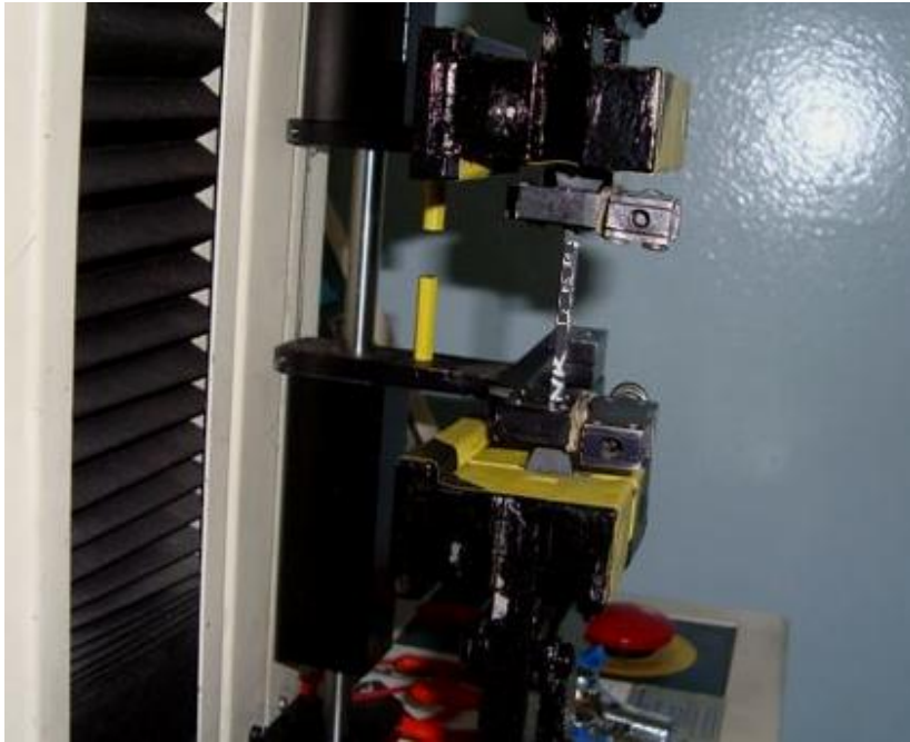
Resim 7.20. Kopma - kopma anı uzama testi
