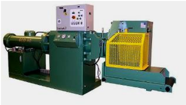
Resim 3.4. Barwell kauçuk şekillendirme makinesi
