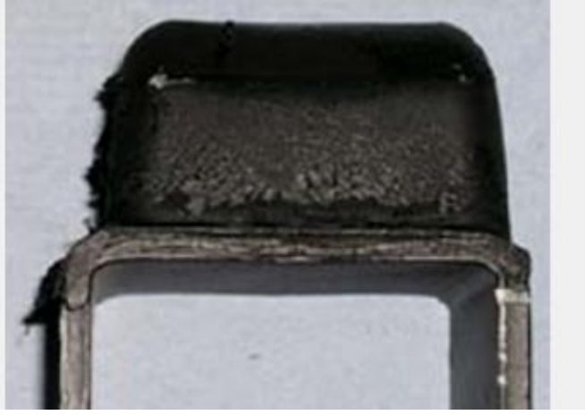
Resim 8.6. TP3 parçası yapışma testi
