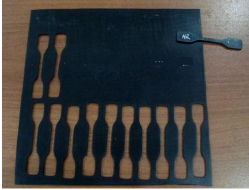
Resim 7.16. Kopma testi plakası ve numunesi
