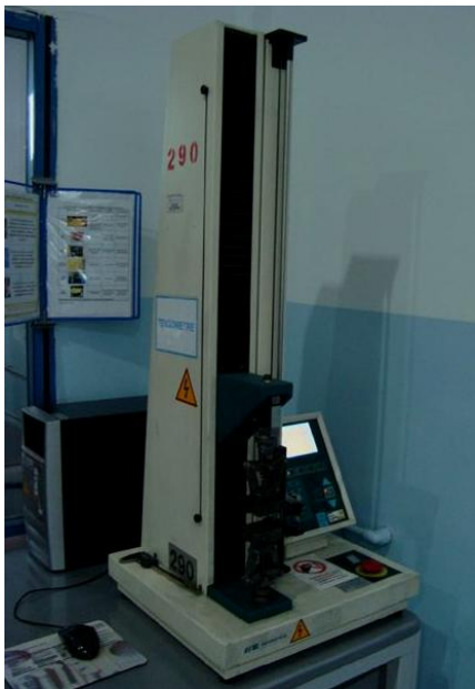
Resim 7.17. Tensometre test cihazı
