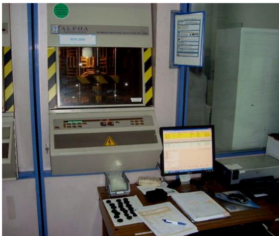
Resim 7.13. Rheometre test cihazı
