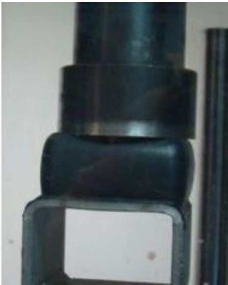
Resim 8.3. TP3 parçası esneme testi
