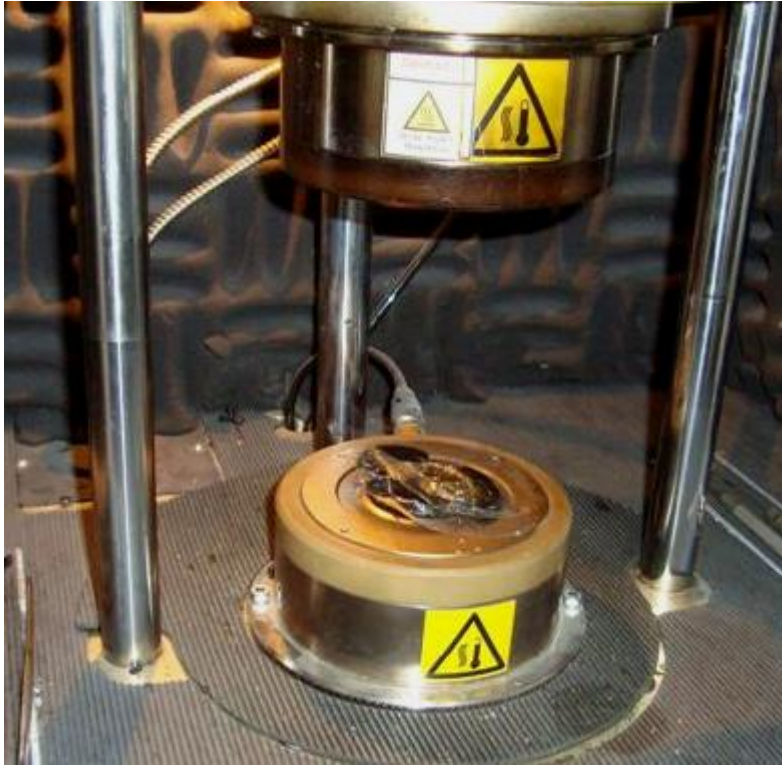
Resim 7.19. Rheometre cihazında testin yapılması
