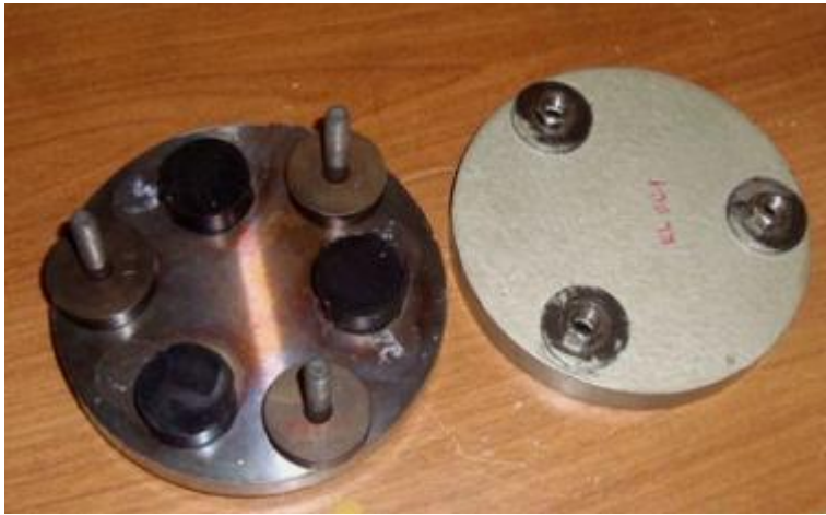
Resim 7.10. Kalıcı deformasyon test aparatı
