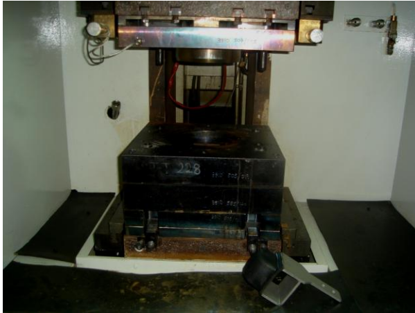
Resim 7.6. TP3'ün UHP presi kalıbı
