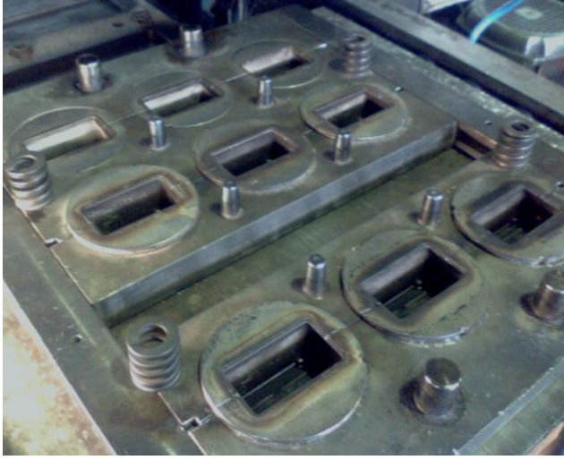
Resim 7.3. TP1-TP2 iletme ortak üretim kalıbı
