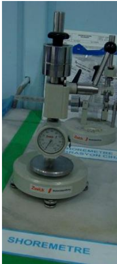
Resim 7.18. Shoremetre test cihazı
