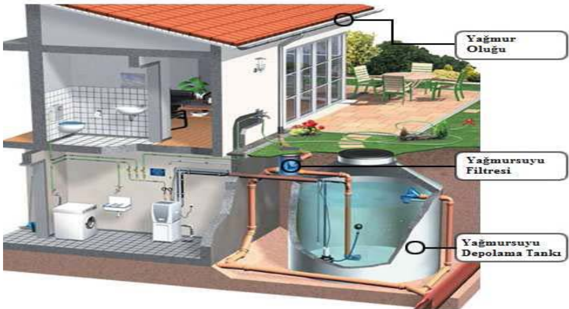
Resim 3.2. Yağmur suyu toplama ve yeniden kullanma sistemi
