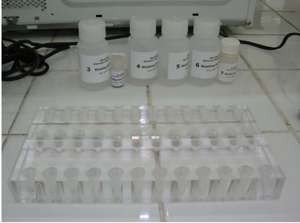
Şekil 3.7. BILATEC Manyetik Separatör (M12+M12) ve kit içeriği
