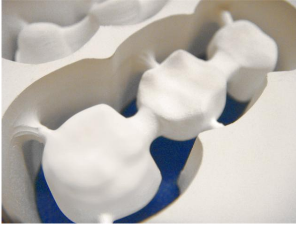
Şekil 2-10: DC-Zirkon sistemi ile elde edilen köprü protezi alt yapısı
