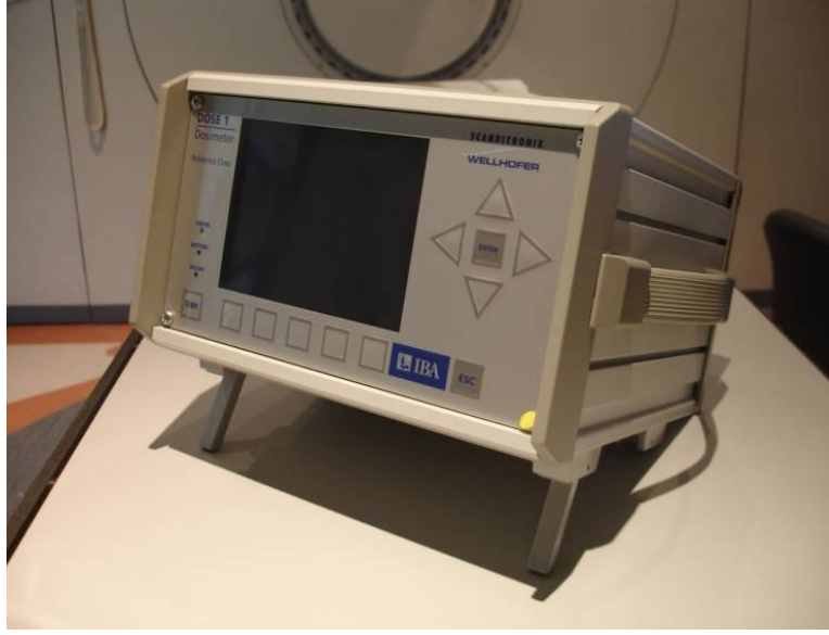
Resim 3.8. “Scanditronix Wellhöfer” marka Dose1 elektrometre
