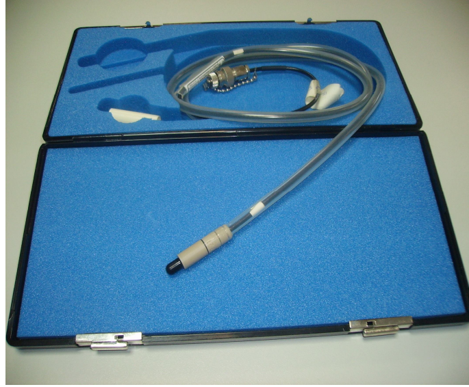
Resim 3.7. “Scanditronix Wellhöfer” marka CC_{13}/TNC tipi iyon odası
