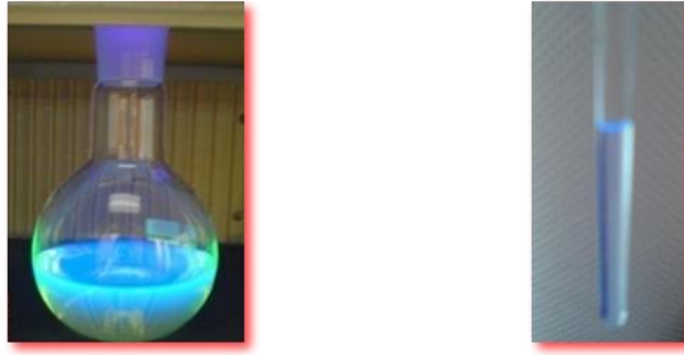
Şekil 4. 42. Trisiyanoantrasen'in 209 seyreltik çözeltisinin a) UV ışığında, b) gün ışığında görünümü
