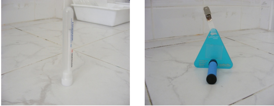
Şekil 3.3. Absorplayıcı silika jel ve üçgen plakaya takılmış örnekleme tüpü
