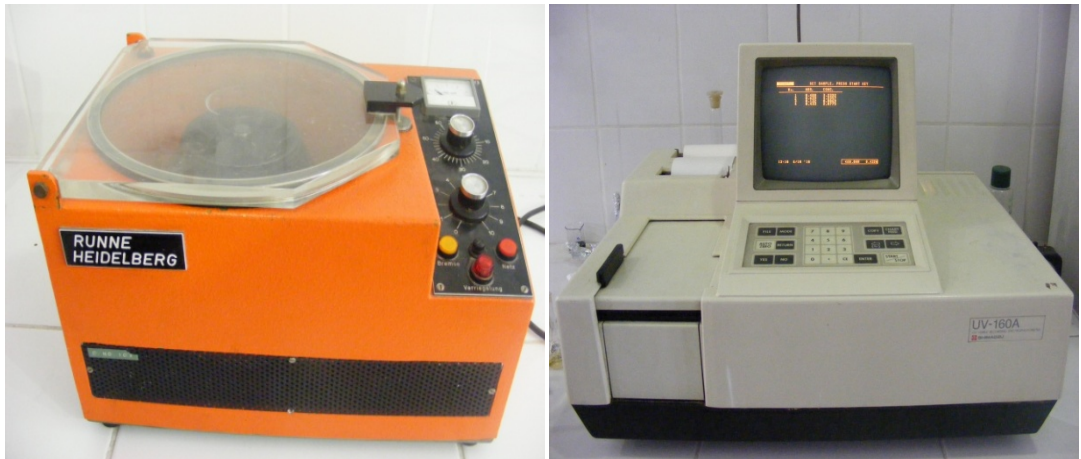
Şekil 3.5. Ozon ekstraksiyonu ve analizinde kullanılan karıştırıcı ve spektrofotometre
