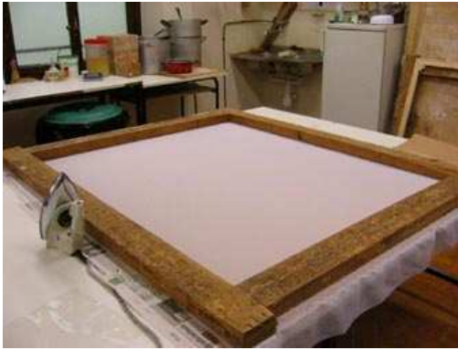
Resim 144, 145 – Gerilen sentetik rantualaj bezi ve hazırlanan BEVA
