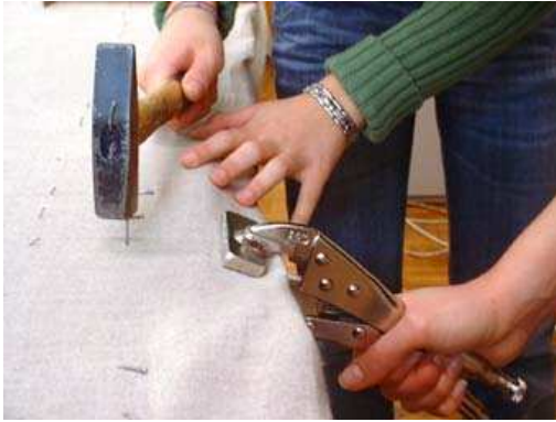
Resim 120– Germe maşalarıyla karşılıklı kenarların gerilmesi
