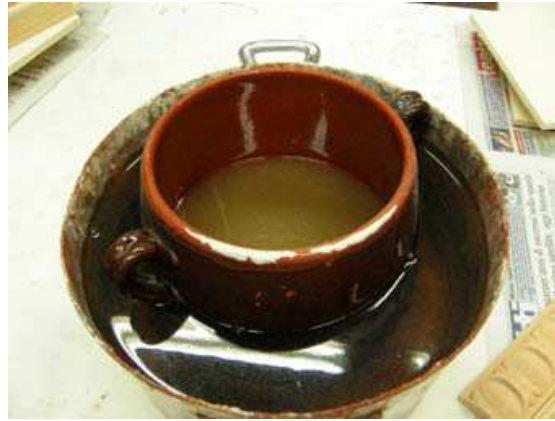
Resim 41 – Benmari usulü ısıtılan colletta
