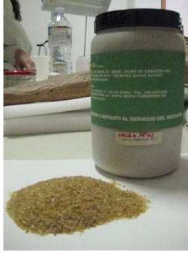
Resim 189 – Tavşan derisi tutkalı kıkırdak tutkalından daha hafif bir yumuşaktır. Gereken sertliğe göre tutkal cinsi seçilebilir.
