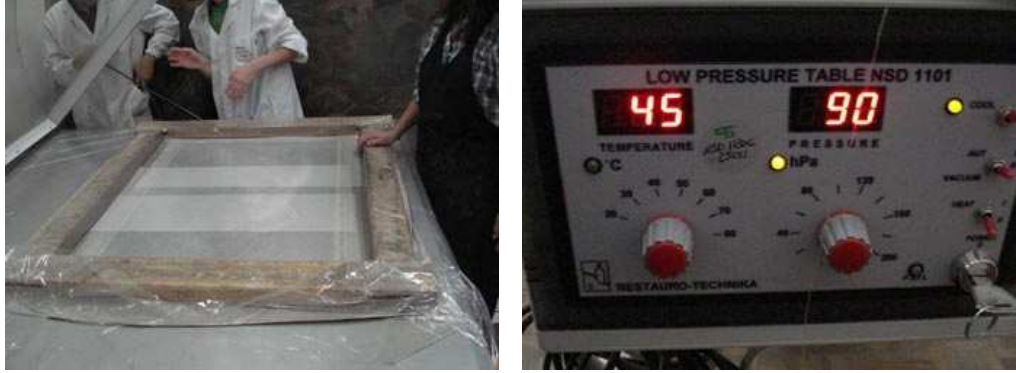
Resim 158,159 - Resim rantualaj beziyle birlikte alçak basınçlı soğuk masada vakumlanır.
