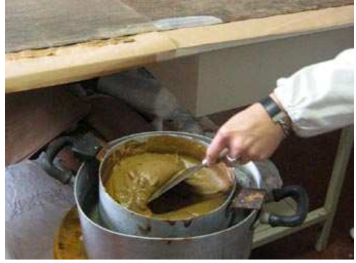
Resim 130, 131 – Donmuş zambak hamuru benmari usulü eritilir ve dişli perdahlarla sürülür.
