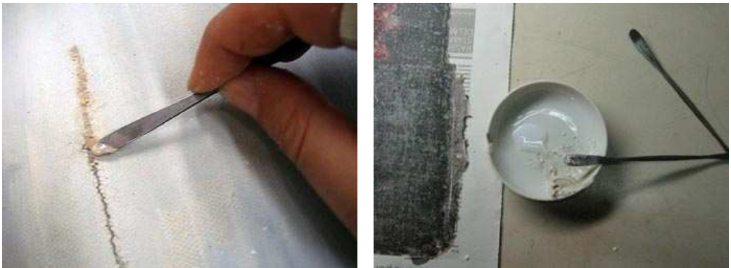
Resim 107, 108 – Yapıştırıcı ve alçı oranı uygulanan alana göre ayarlanır.
