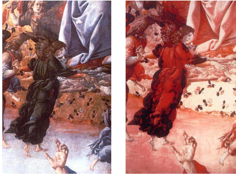
Resim 15, 16 - Aynı detayın normal ışıkla ve sahte renkli IR filmle çekimi. IR ışıkla yapılan ikinci çekimde figürün elbisesinde iki farklı renk alanı görünüyor. Koyu alanlar IR dalgalarını absorbe etme özelliğine sahip bakır bazlı yeşille yapılan orijinal alanları; diğer alanlar ise restorasyonda kobalt bazlı yeşille yapılan rötuşları gösteriyor.
