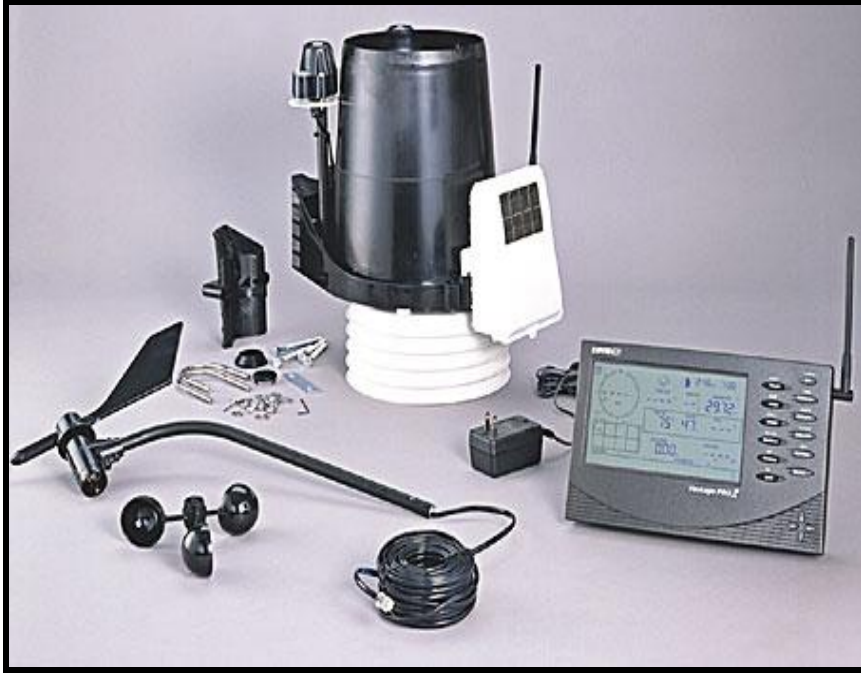
Şekil 3.1. Kullanılan otomatik kablosuz meteoroloji istasyonu *Davis Vantage Pro2 Plus Wireless Weather Station
