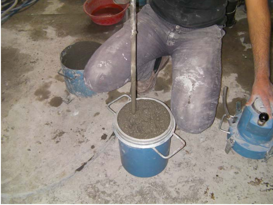
Resim 3.3. Taze betonun hava miktarı tayini deneyinin yapılışı
