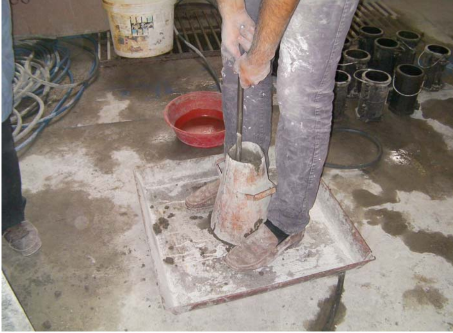
Resim 3.1. Slump deneyinin yapılışı
