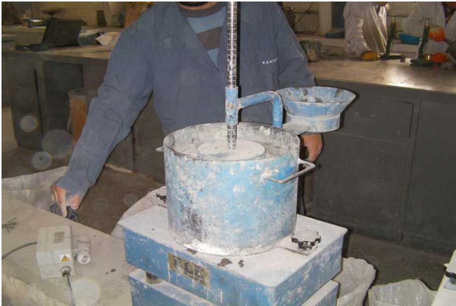
Resim 3.2. Taze betonun Ve-Be süresi tayini deneyinin yapılışı
