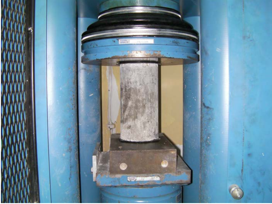
Resim 3.4. Basınç dayanımı deneyinin yapılışı
