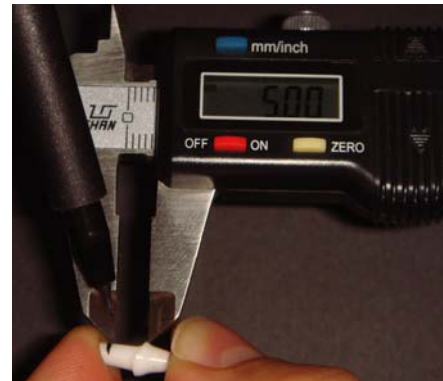
Resim5.30 Procera ve Astratech abumentların kalibrasyonu
