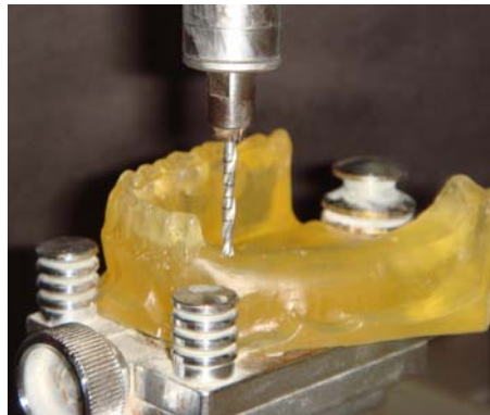
Resim 5.1 İmplant yuvalarının paralelometrede açılması
