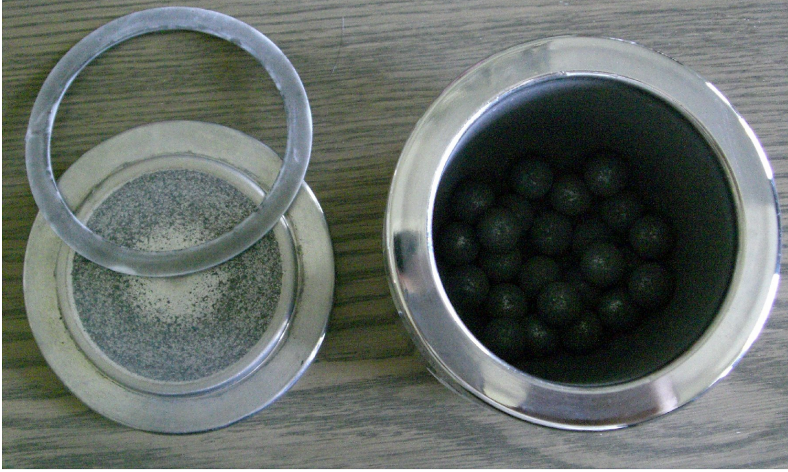
Şekil 3.3. Mekaniksel alaşımlama cihazının numune haznesi
