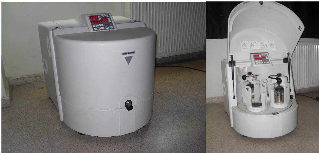
Şekil 3.1. Mekaniksel alaşımlama cihazının iç ve dış görünüşleri
