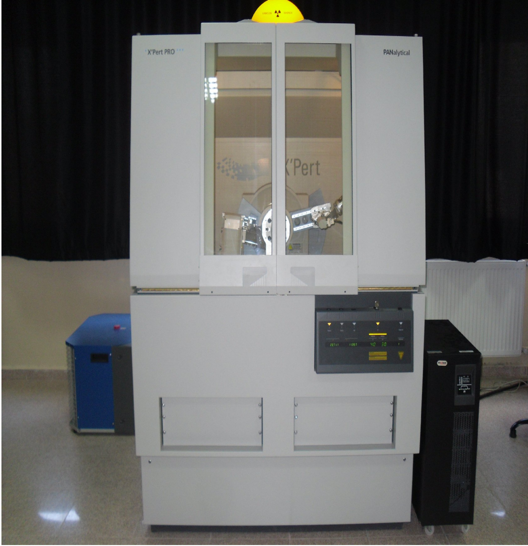
Şekil 3.8. Philips X'Pert PRO marka X- ışını difraksiyonu cihazı.
