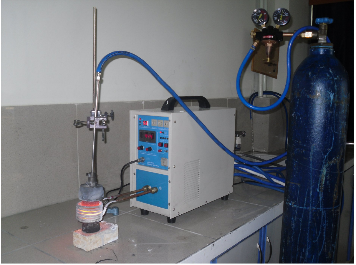
Şekil 3.4. Normal katılaştırma için kullanılan fırın sistemi
