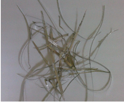
Şekil 3.6. Hızlı katılaştırma ile üretilen şeritler
