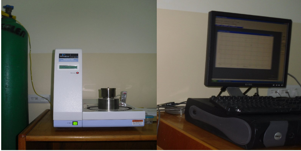
Şekil 3.10. Perkin Emler - Sapphire DSC cihazı
