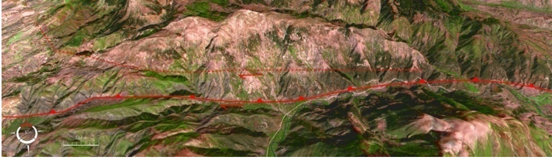
Şekil 4.26 : Taşova Fayı'nın SRTM verisi üzerine izdüşürülmüş IRS-1C ve LANDSAT TM karma verisi ile 3 boyutlu görünümü, kesik çizgili hatlar ise inaktif fayları göstermektedir.
