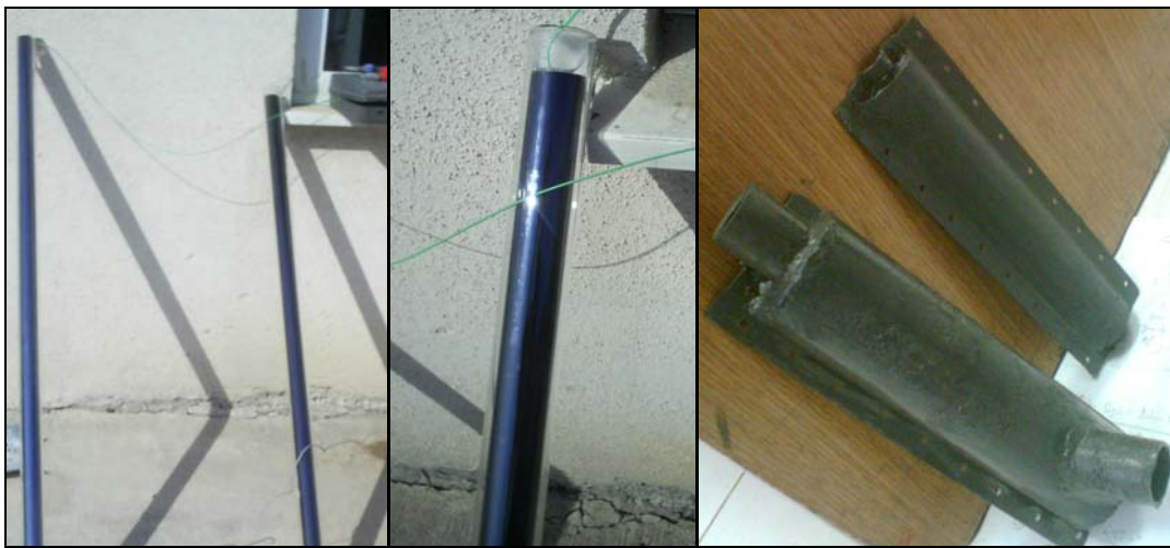
Resim 4.10. Vakumlu cam tüp için basit deney düzeneği ve imalatı yapılan depo.
