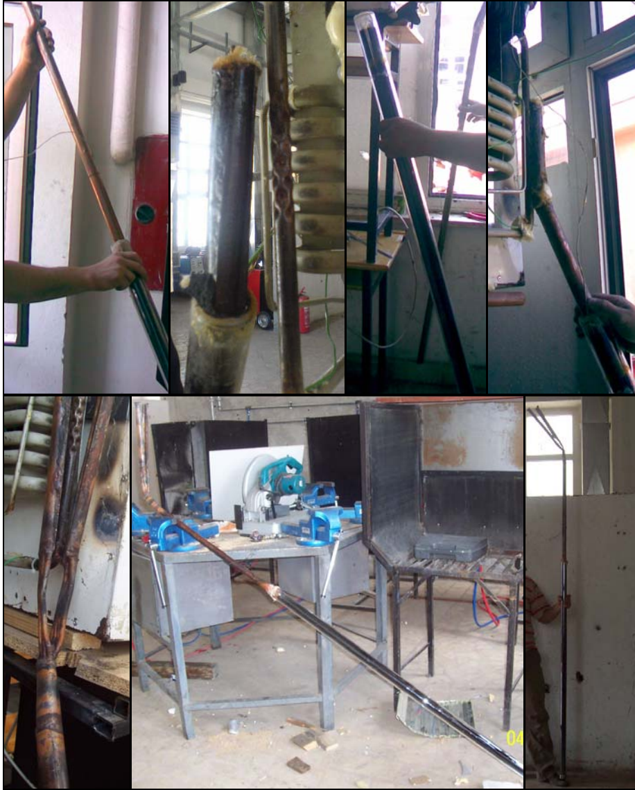
Resim 4.12. Tarafımızdan yapılan ısı borusu ile vakumlu cam tüpün ortak kullanımı.
