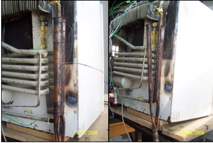
Resim 4.15. YSS2 sistemlerinde ısı borusu deposunun bağlantısı.
