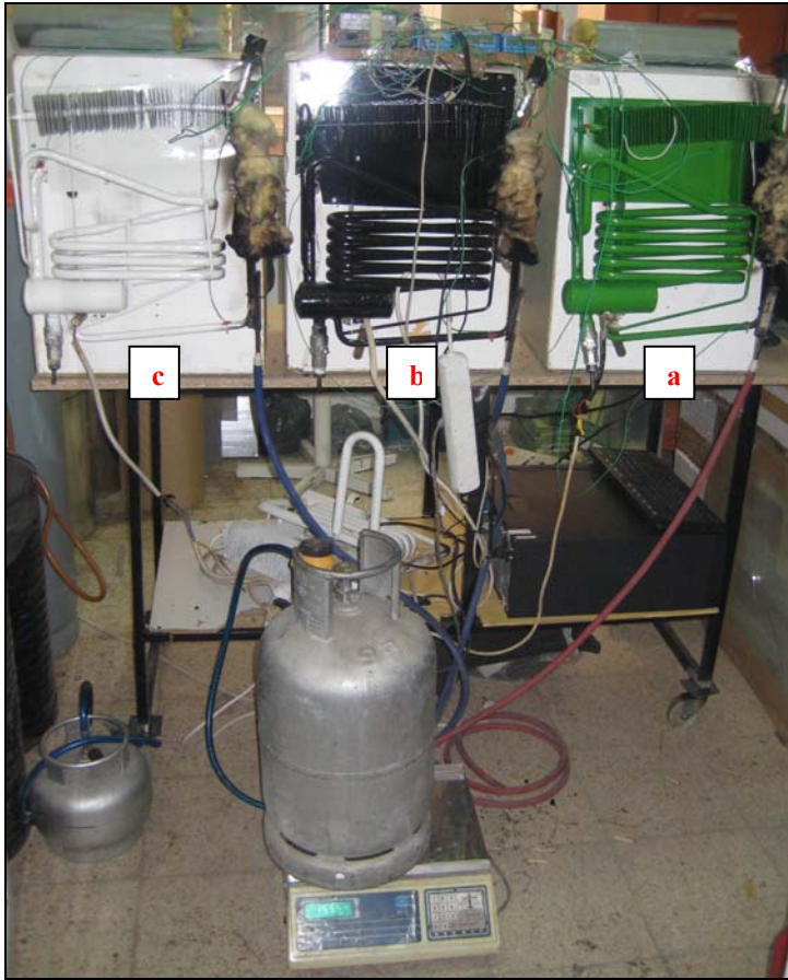
Resim 4.5. YSS1 (a), YSS2 (b) ve YSS3 (c) için LPG kullanımının deney düzeneği.
