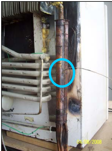
Resim 4.17. Güneş enerjili YSS1 ve YSS2 için ısı borusu deposu ölçüm yeri.
