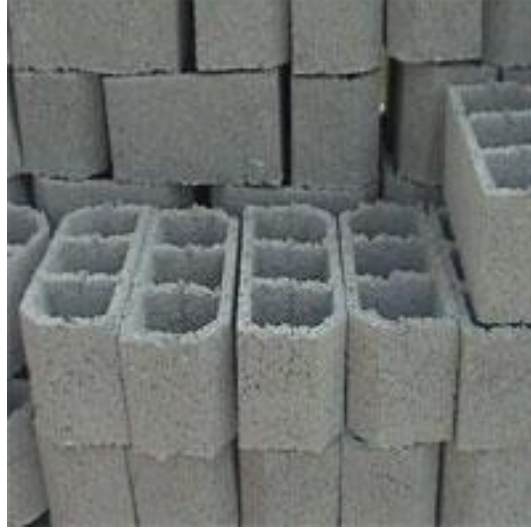
Şekil 4.24 Bims Blokların Açık Havada Doğal Kurutma İçin Bekletilmesi.
