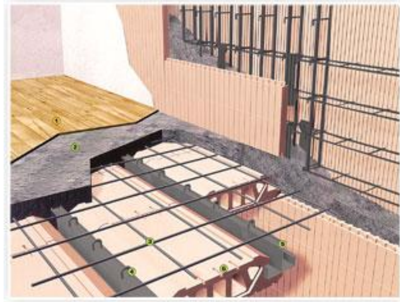
Şekil 4.52 Prefabrik Kirişlere Uyumlu Dolgu Blok EPS Uygulaması ( www.mubaizoyapi.com )
