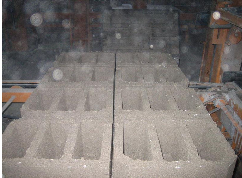
Şekil 4.23 Bims Blokların Güneş Almayan Kapalı Bir Ortamda Kurutulması
