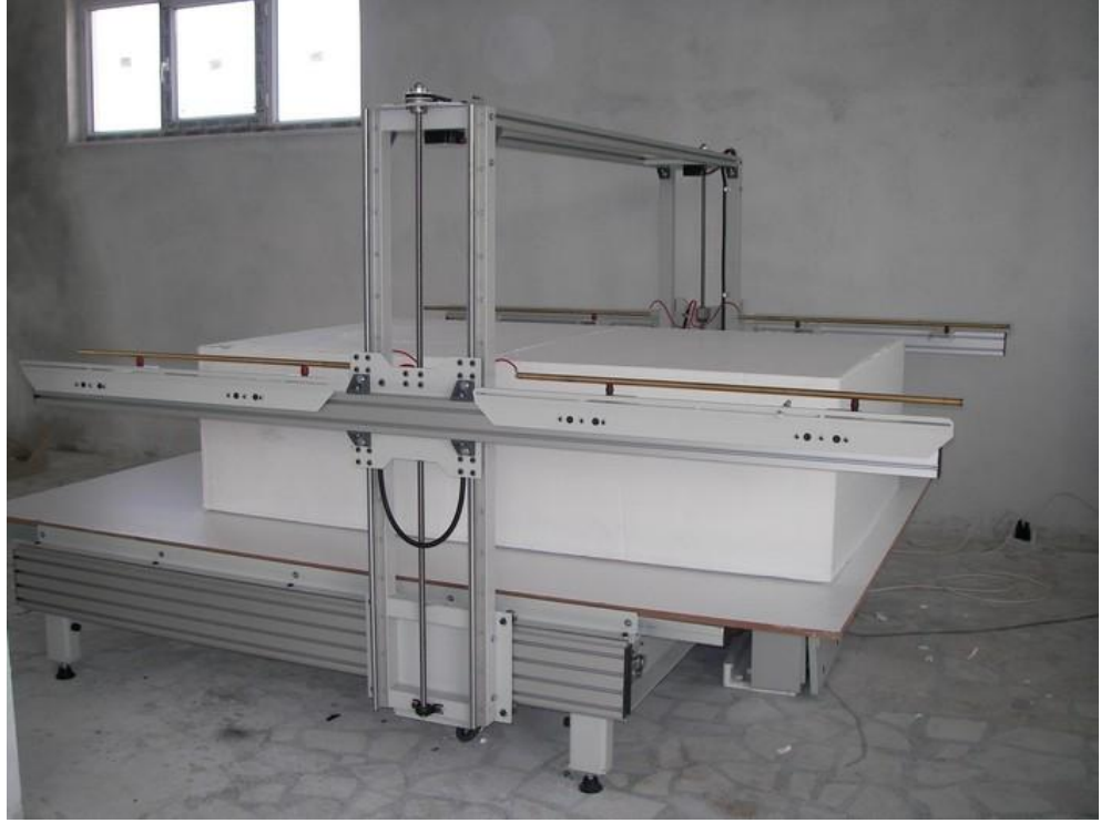
Şekil 4.38 EPS Blokların Sıcak Tel İle Kesilip Boyutlandırılması
