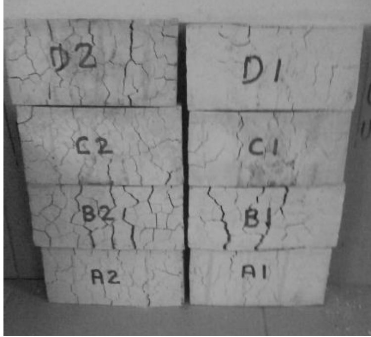
Şekil 4.18 900 °C Yakılmış Bir Grup Numune
