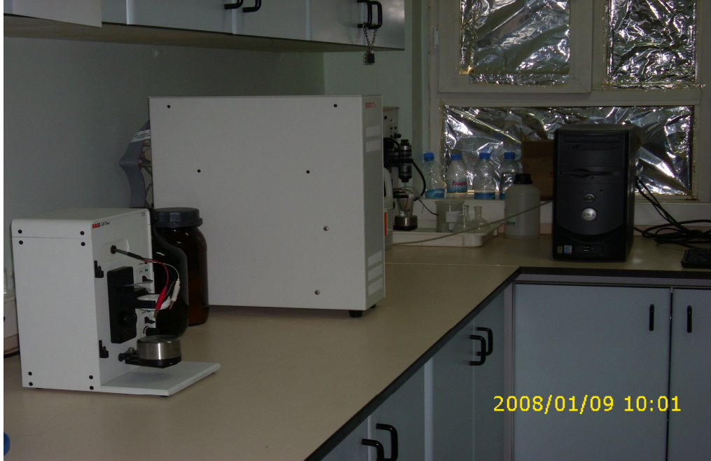
Şekil 3.1. 100B/W BAS üç elektrotlu elektrokimyasal analiz cihazı.
