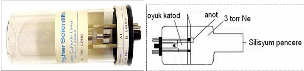
Şekil 2.5. Atomik absorpsiyon spektroskopisinde kullanılan lambalar.
