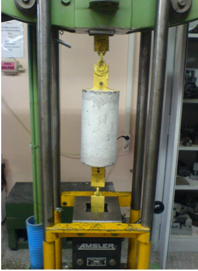
Resim 5.12. Betonun doğrudan çekme dayanımı deneyi düzeneği
