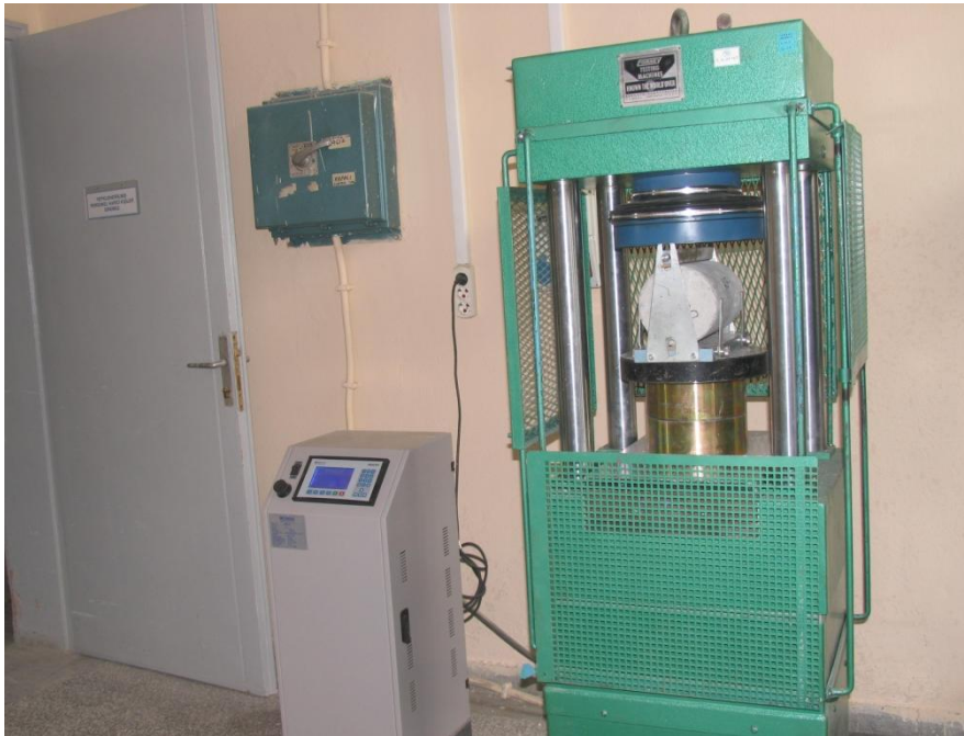
Resim 5.8. Betonun yarmada çekme dayanımı deneyi düzeneği
