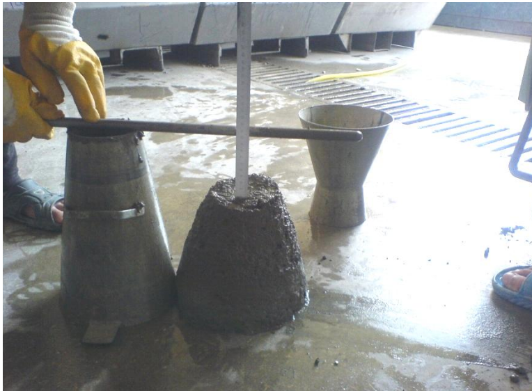
Resim 5.5. Çökme deneyinin yapılışı
