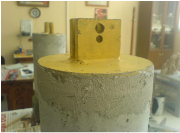
Resim 5.11. Metal başlığın numuneye yapıştırılmış hali
