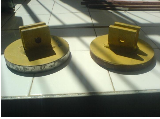
Resim 5.9. Beton numunenin alt ve üst yüzlerine yapıştırılan metal başlıklar
