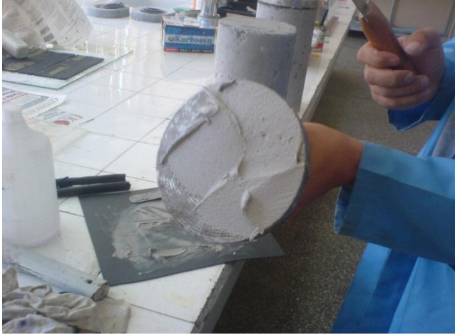
Resim 5.10. İki bileşenli epoksi yapıştırıcının metal başlığa uygulanması
