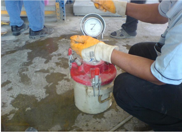
Resim 5.6. Hava miktarı deneyinin yapılışı
