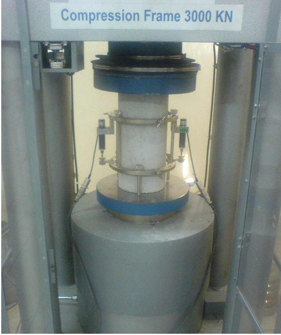
Resim 5.14. Elastisite modülü deney düzeneği
