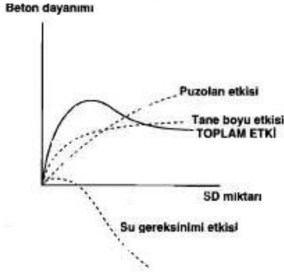
Şekil 3.1. Silis dumanının betonun dayanımına etkisi
