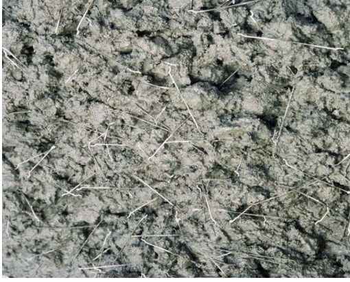
Resim 3.1. Çelik lifli betonda liflerin gelişigüzel dağılımı.
