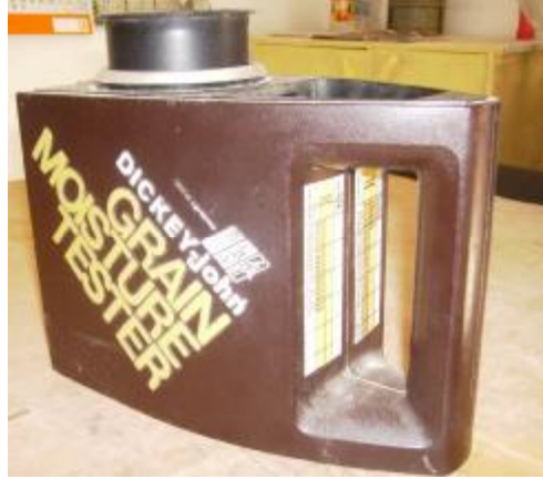
Şekil 3.9. Nem ölçer cihazı
