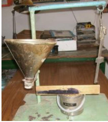
Şekil 3.7. Hektolitre ölçüm düzeneği
