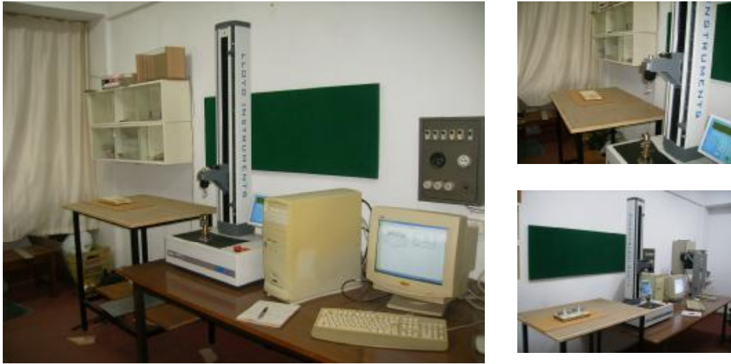
Şekil 3.4. Lloyd biyolojik materyal test cihazı
