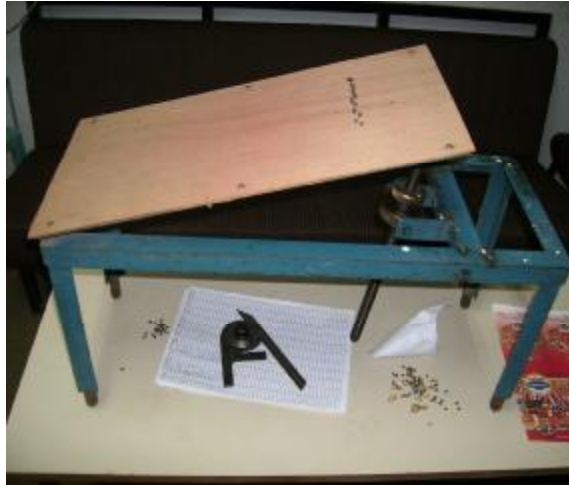
Şekil 3.8. Eğik düzlem düzeneği
