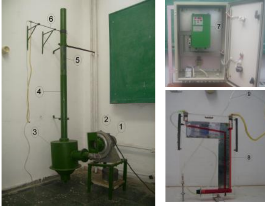
1. Motor, 2.Fan, 3.Hava karışım odası, 4.Düşey boru, 5.Gözetleme penceresi, 6.Pitot tüpü, 7.Varyatör, 8.Eğik Diferansiyel Manometre, 9.Plastik hortumlar
