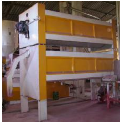
1.Elevatör, 2. ve 3. Triyör silindirleri, 4.Toz ilaçlama, 5.Sıvı ilaçlama tankı, 6.Karıştırıcı helezon
