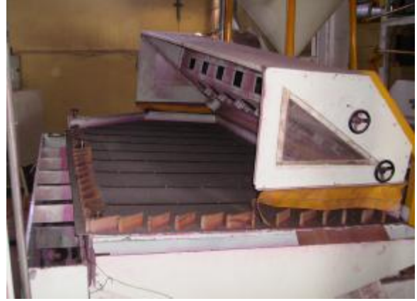
1.Elevatör, 2.Ürün bekleme bunkeri, 3.Üst fan, 4.Gravite tablası
