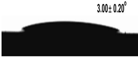
Şekil 5.4. Islak aşındırma ve UV/O 3 tekniği ile hidroksilenmiş hidrofilik yüzeyin su değme açısı görüntüsü
