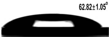
Şekil 5.3. Hidroksillenmeden önceki Si yüzeyin su değme açısı görüntüsü
