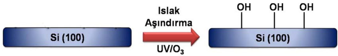
Şekil 5.1. Hidrofilik yüzeyin şematik gösterimi
