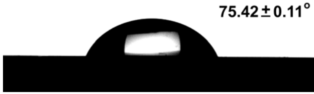
Şekil 5.10. BPTS bağlı yüzeyin su değme açısı
