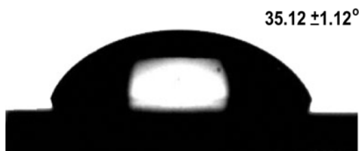
Şekil 5.14. Çapraz bağlı PHEMA filmlerinin su değme açısı görüntüsü
