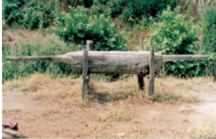
Resim 11. Keçeleştirme işleminin yapıldığı düzenek, “dink”. 38
