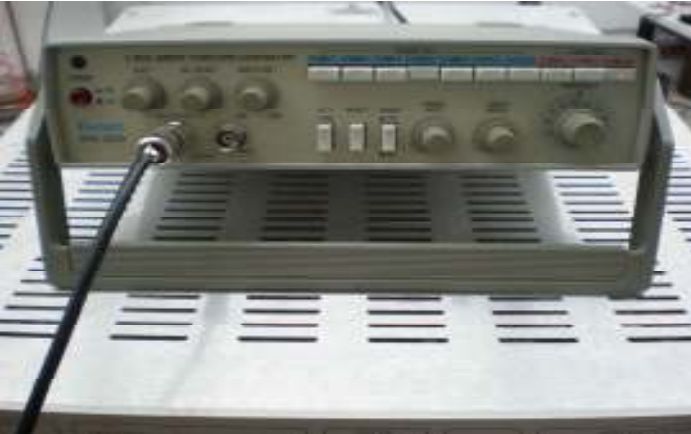
Şekil 3.3. Escort EFG–3210 sinyal üretici
