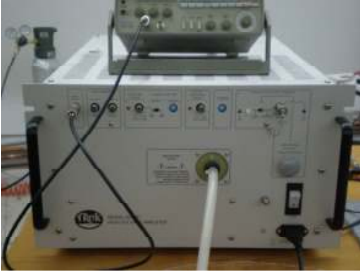
Şekil 3.4. Trek model 20/20C yüksek gerilim üretici
