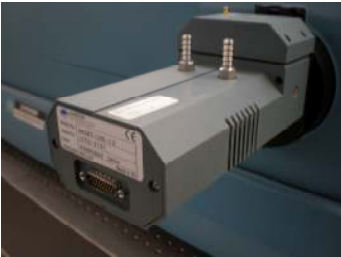
Şekil 3.5. ANDOR Technology DH5H7- 18S -13 çoklayıcı CCD kamera
