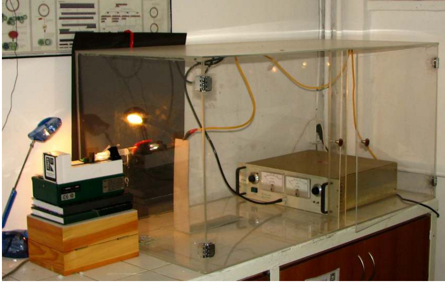
Şekil 3.2. Nanofibriler PHB doku iskelesi hazırlanmasında kullanılan düzenek
