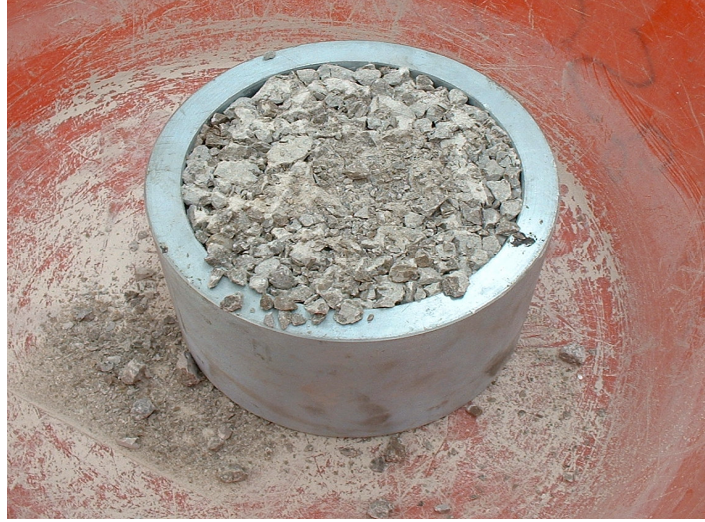
Şekil 5.5 400 kN yük altında sıkıştırılmış agrega numunesi.
