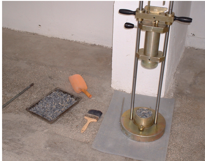
Şekil 5.3 Yerine yerleştirilmiş çelik silindir kap.
