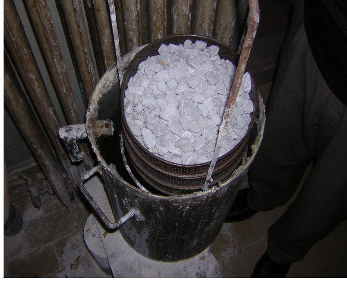
Şekil 5.6 Agreg a numunesinin sodyum sülfat çözeltisinde kür edilmesi.
