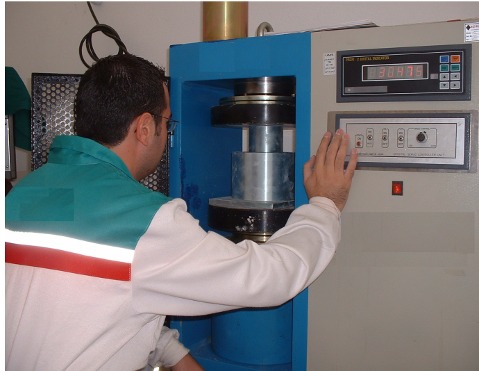
Şekil 5.4 Agreganın numunesinin basınç altında sıkıştırılması.
