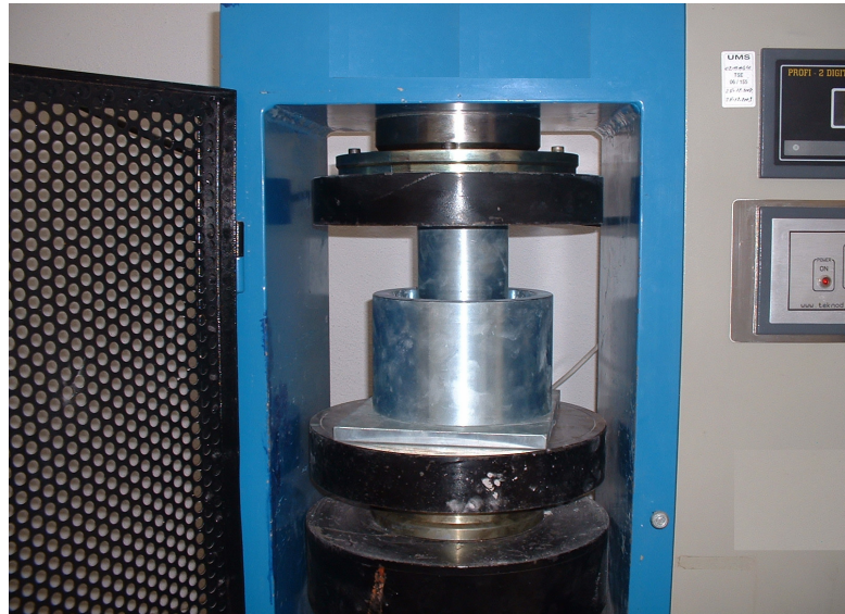
Şekil 3.4 Prese yerleştirilmiş kırılma katsayısı deney düzeneği.
