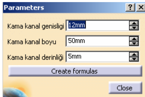
Şekil 10.65. Kama kanalı parametre penceresi
