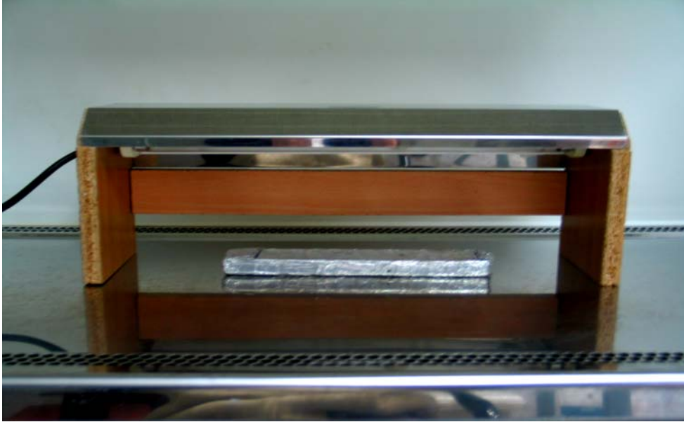
Şekil 3.4 UV lambasının kurulduğu düzenek
