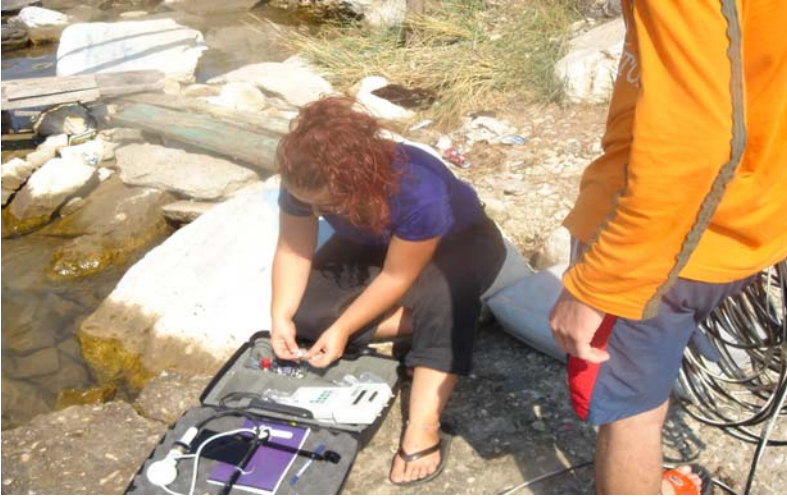
Şekil 3.2. LI-1400 Data Logger'ın ve LI-190 SA (terrestrial) quantum sensörünün ve uzun su altı kablosu ile LI-193 SA'nın ölçüme hazırlanması
