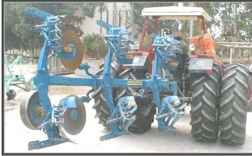
Şekil 3.4. Üç gövdeli döner kulaklı pulluk ve deneme traktörü
