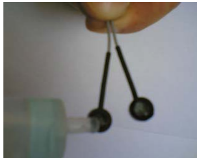
Şekil 4.5. Çalışmada Kullanılan Elektrotların Jel İle Doldurulması
