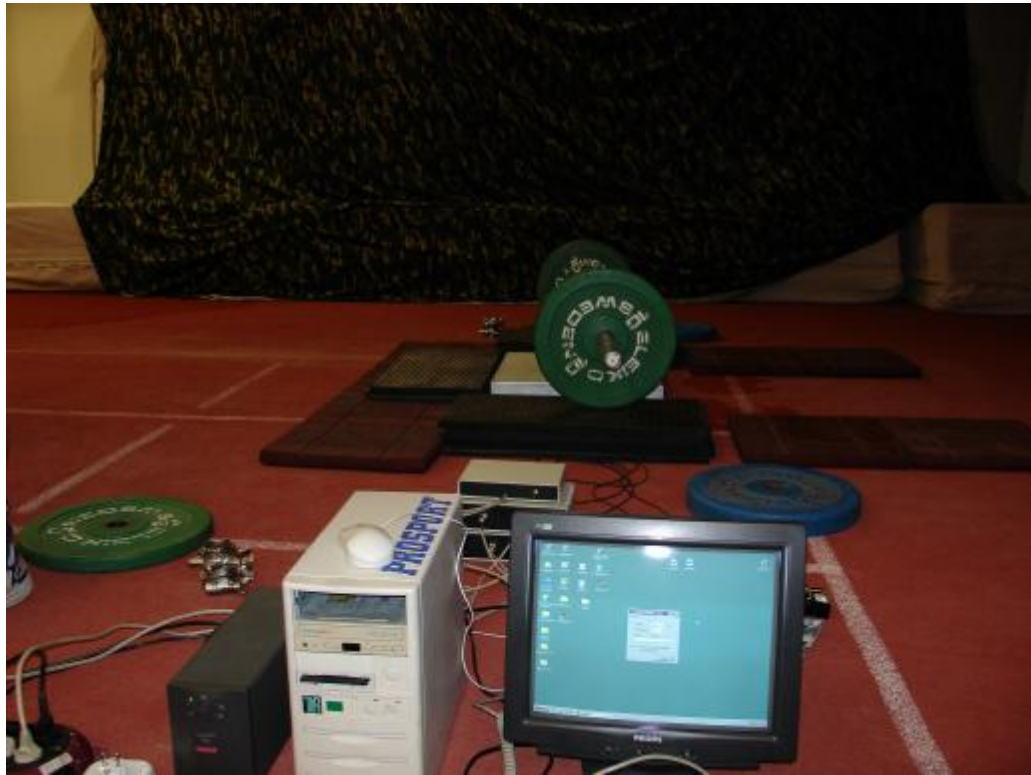
Şekil 3.5. Yer tepki kuvveti ölçme sisteminin deney sırasındaki kullanımı
