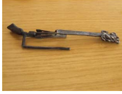
Şekil 4.17. (K, A) = (DH, T) türü kilidin hareketli parçaları.
