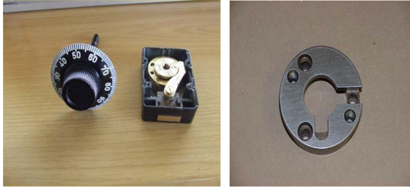
Şekil 4.30. Kasa kilidi mekanizmasının birimleri ve içindeki bir plaka.
