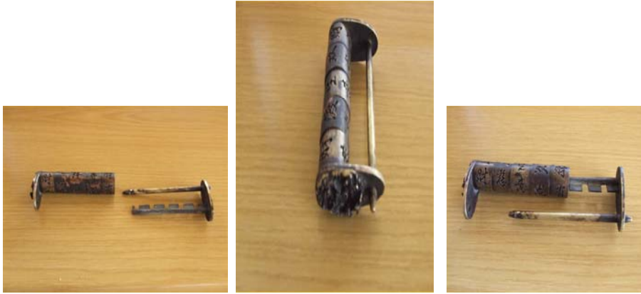
Şekil 4.28. Şifreli Çin kilidi mekanizmasının açık ve kapalı durumları.
