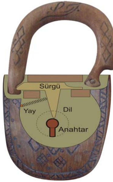
Şekil 2.68. Ahşap Gerede KİLİDİ iç mekanizması.
