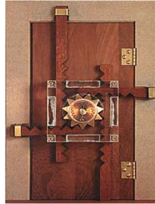
Şekil 2.52. Dört sürgülü kasa kapısı kilit modeli (Sezgin, 2003).
