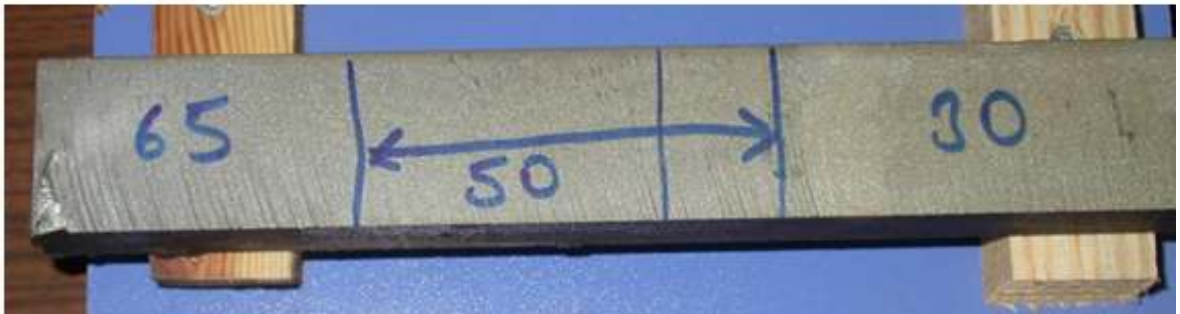
Şekil 5.143. A Tipi Uygulamada Çizik Oluşumu. Malzeme: St-42; Kalınlık: 30 mm; İlerleme Hızları: 30,50 ve 65 mm/dk; Basınç: 3000 bar (MAJET, İstanbul, 2006)
