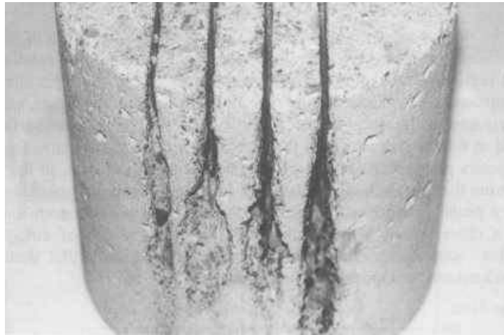
Şekil 4.4. Kırılğan Beton Malzemede Cep Oluşumu (Momber, et al.,1995)
