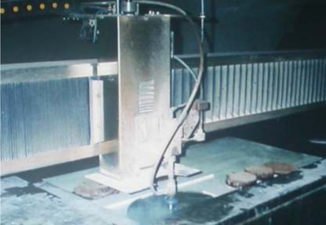
Şekil B2. ASJ Tezgâhında Taşıyıcı Konsol ve Kesme Kafası (MAJET, 2006)
