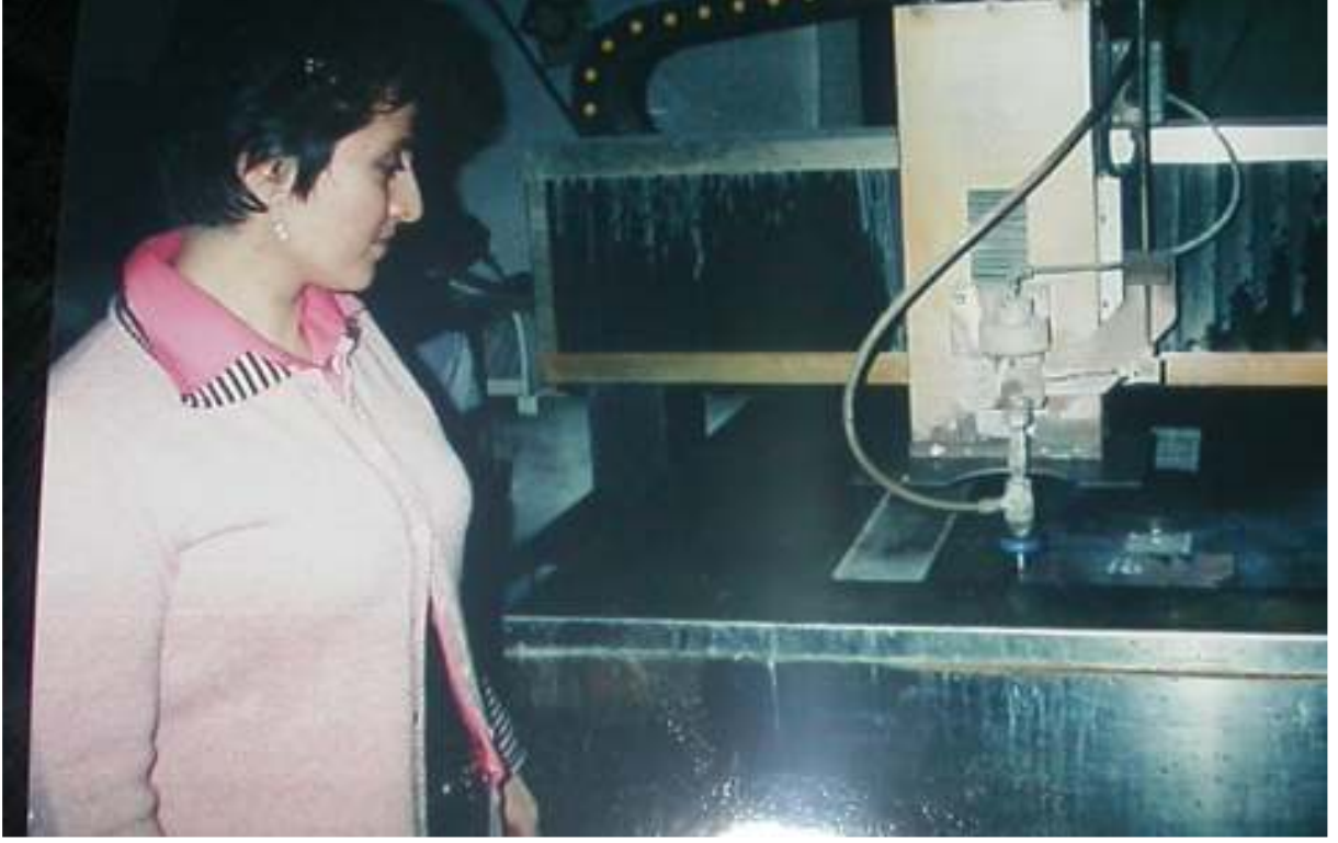
Şekil A1. ASJ Tezgâhında Kesme Kafasının Görünüşü (MAJET, 2006)
