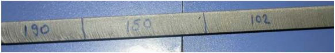
Şekil 5.142. B Tipi Uygulamada Çizik Oluşumu. Malzeme: St-42; Kalınlık: 15 mm; İlerleme Hızları: 102, 150 ve 190 mm/dk; Basınç: 3000 bar (MAJET, İstanbul, 2006)
