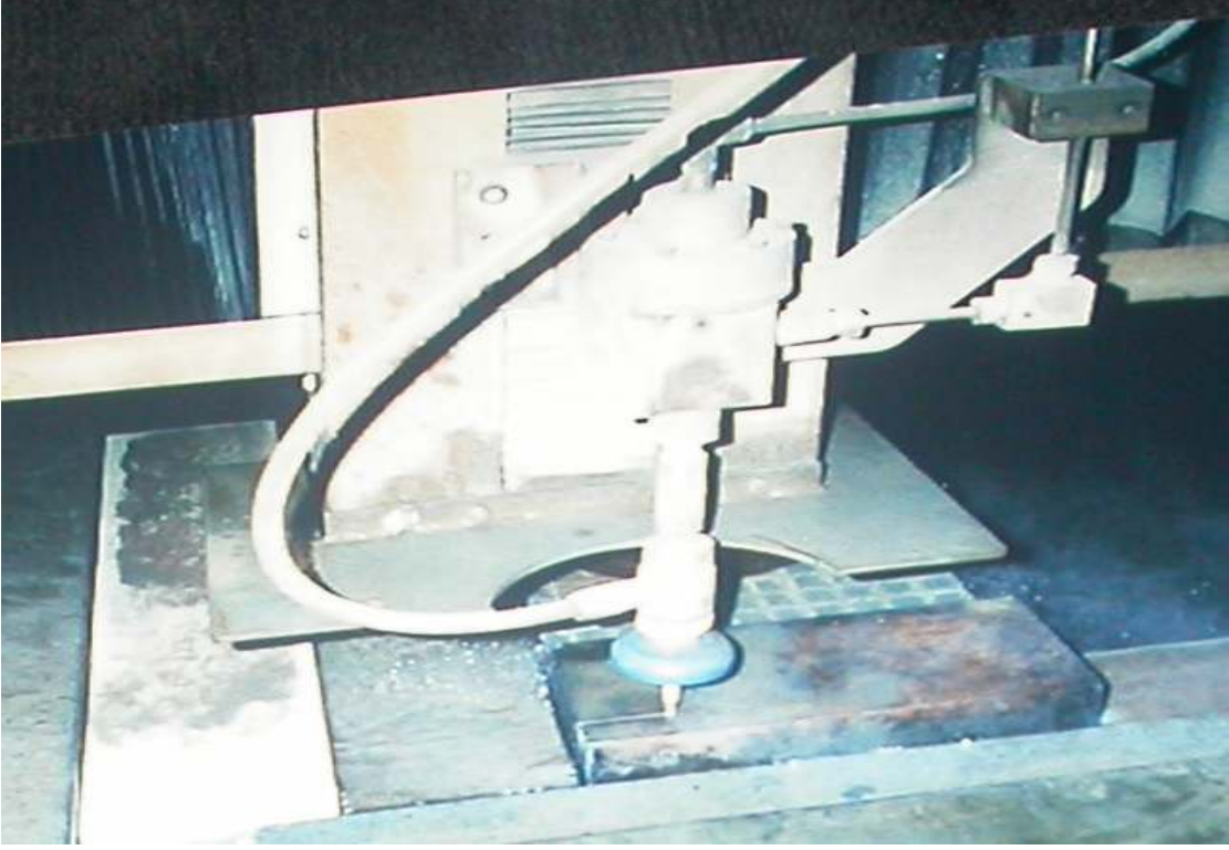
Şekil B1. ASJ Tezgâhında Kesme Nozulu ve Aşındırıcı Hattı (MAJET, 2006)
