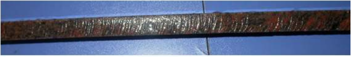
Şekil 5.149. A Tipi Uygulamada Çizik Oluşumu. Malzeme: Granit; Kalınlık: 20 mm; İlerleme Hızları: 250 ve 600 mm/dk; Basınç: 3000 bar (MAJET, İstanbul, 2006)
