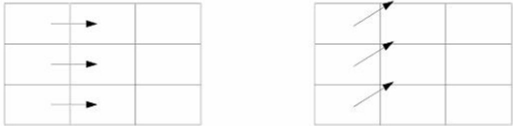
Şekil 3. 15. Sayısal difüzyon açısından iki ağ karşılaştırılması (İlk ağ daha doğrudur)
