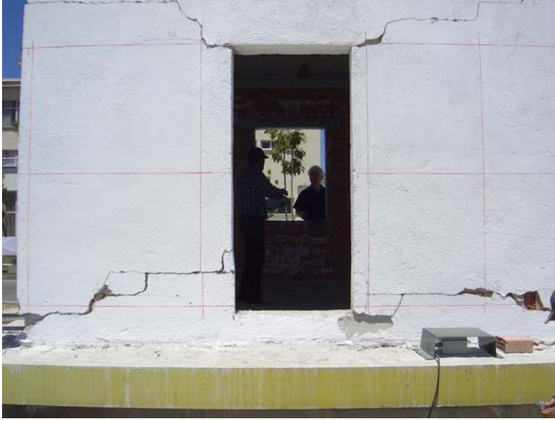
Resim 3.15. Deney Yapısı-1 güney cephenin 15. yükleme sonunda görünüşü
