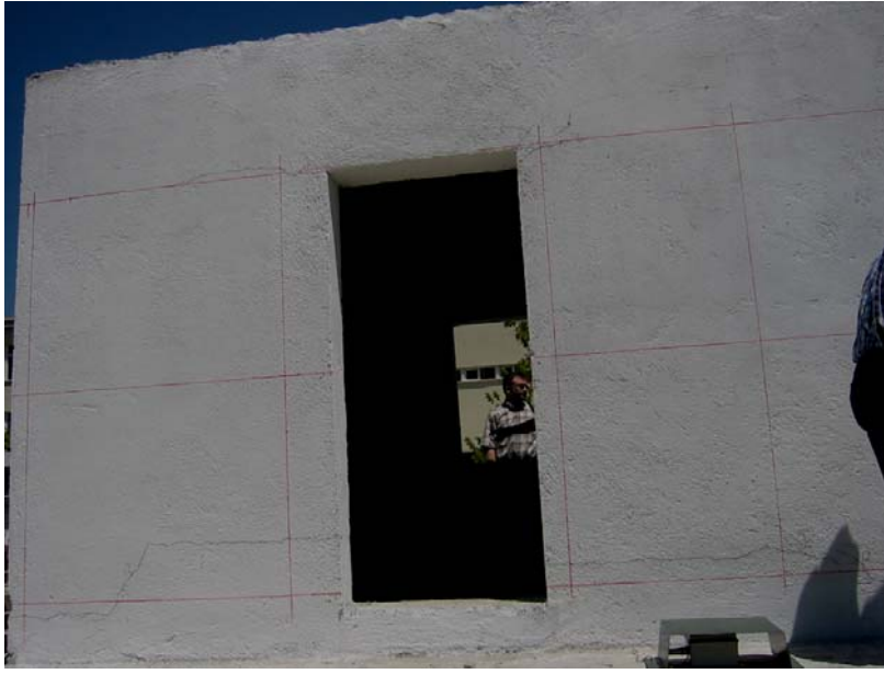
Resim 3.3. Deney Yapısı-1 güney cephenin 11. yükleme sonunda görünüşü
