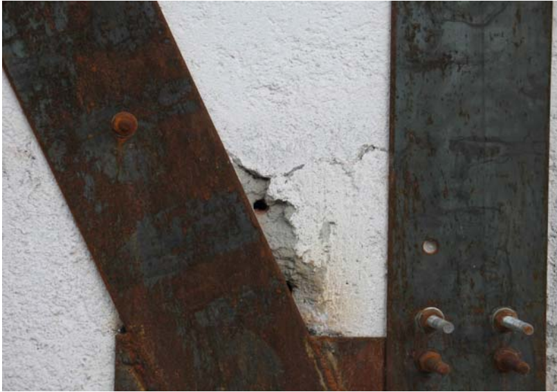
Resim 3.25. Deney Yapısı-2 güney cephe A2 duvar parçasının 18. yükleme sonunda görünüşü
