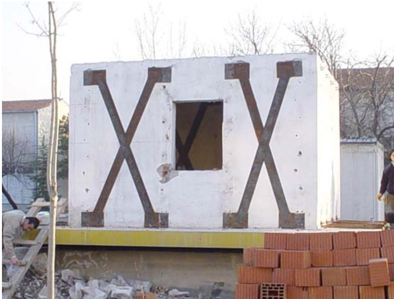
Resim 3.29. Deney Yapısı-4 kuzey cephenin 20. yükleme sonunda görünüşü
