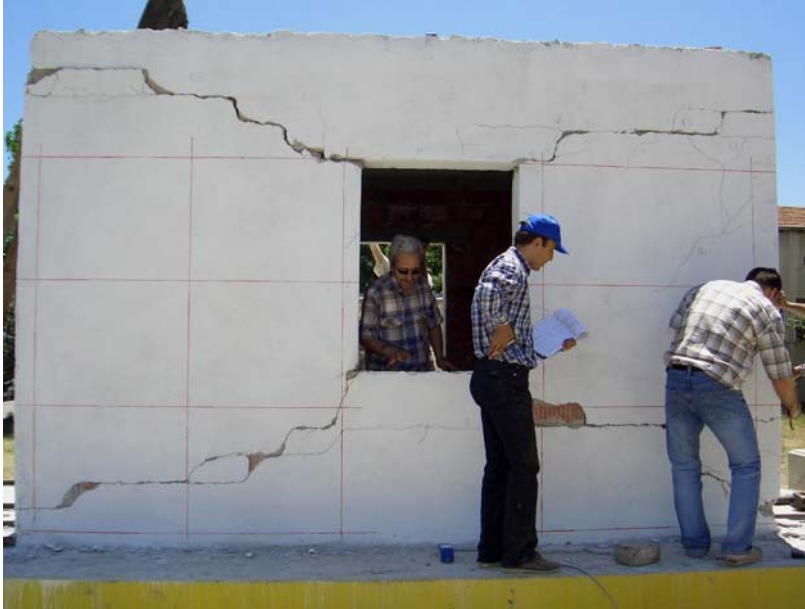
Resim 3.16. Deney Yapısı-1 kuzey cephenin 16. yükleme sonunda görünüşü
