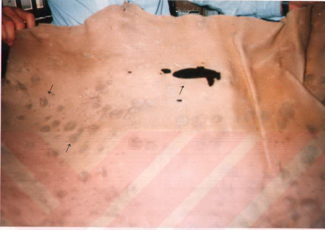
Resim 4. İşlenmiş bir deri örneğinde bakteriyel gelişmeden dolayı derinin sirça yüzeyi üzerinde oluşan yırtılma ve lekeler.
