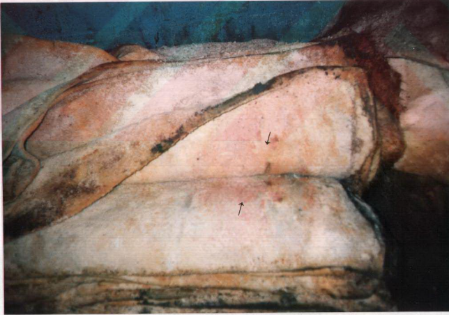
Resim 3. Yanlış yığınlar halinde depolanmış ve yetersiz konserve edilmiş derilerde üreyen halofilik mikroorganizmalar.
