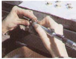
Şekil IV.2.2.3.4. İmalatın son safhası olan tesviye ve parlatma işlemi.
