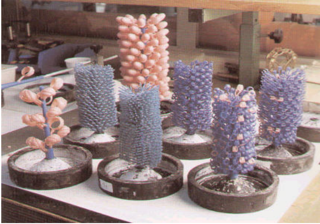
Şekil III.6.3.1. Ağacın oluşturulmasında değişik türlerde mumlar kullanılmaktadır.
