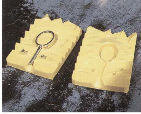
Şekil III.3.4. Model çıkarılmadan açılmış bir kalıp.
