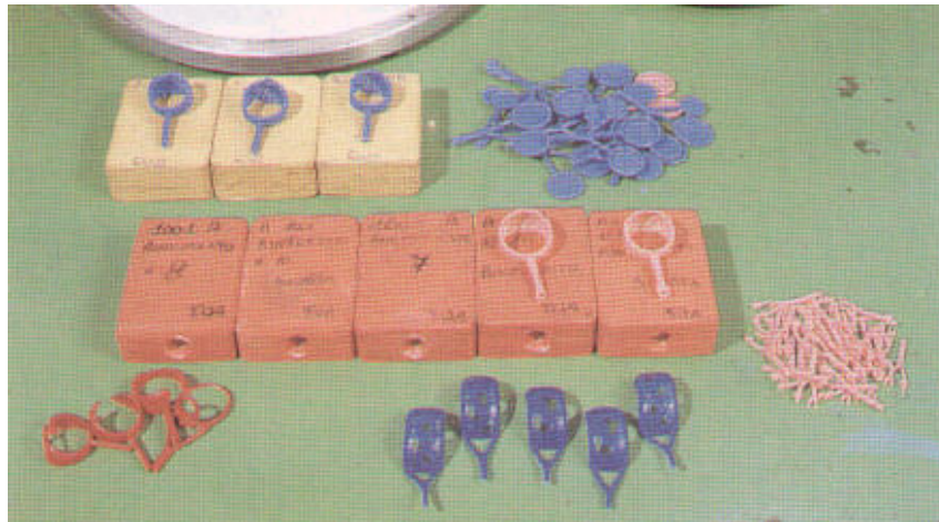
Şekil III.2.1. Hazırlanmış kalıplar ve mum kalıp örnekleri
