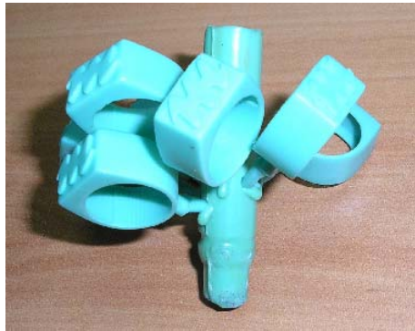
Şekil IV.2.2.3.2. Mumdan yapılmış, imalatı yapılacak olan takı ağacı örneği.
