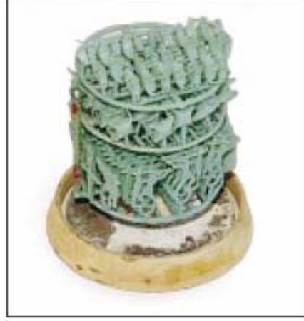
Şekil III.4.1. Mumdan yapılmış bir takı ağacı örneği.
