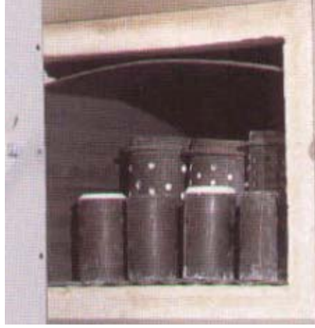
Şekil IV.2.2.1.3. Fırına yerleştirilmiş pişmeye hazır kaplar.
