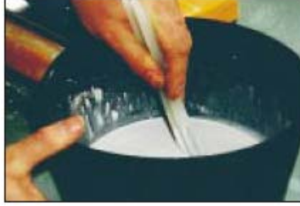
Şekil III.6.5.1.1. Alçının elle karıştırılması.
