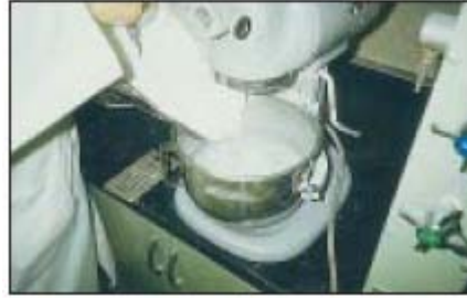
Şekil III.6.5.1.2. Alçının makine yardımıyla karıştırılması.
