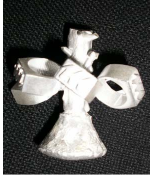
Şekil IV.2.2.3.3. Tasarımı yapılmış modelin, son işlem öncesi oluşturulan takı ağacı.
