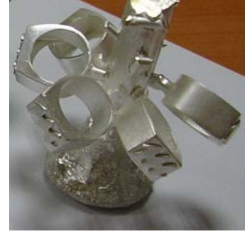
Şekil IV.2.2.3.3. Tasarımı yapılmış modelin, son işlem öncesi oluşturulan takı ağacı.
