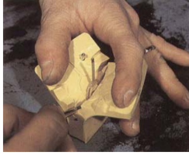
Şekil IV.2.2.2.3. Silikon kauçuğun neşterle kesilmesi.
