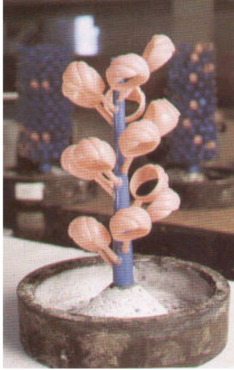
Şekil III.6.2.2. Basit ve kalabalık olmayan bir spiral yerleştirme örneği.
