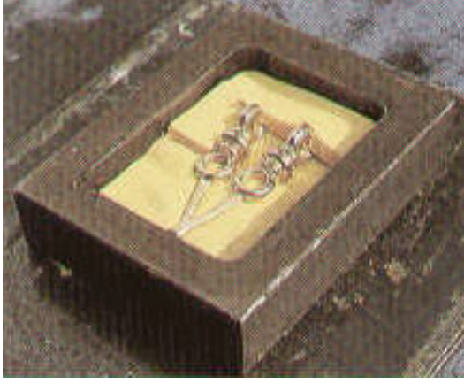
Şekil III.2.2. Model kalıbın ortasına dikkatlice yerleştirilir.
