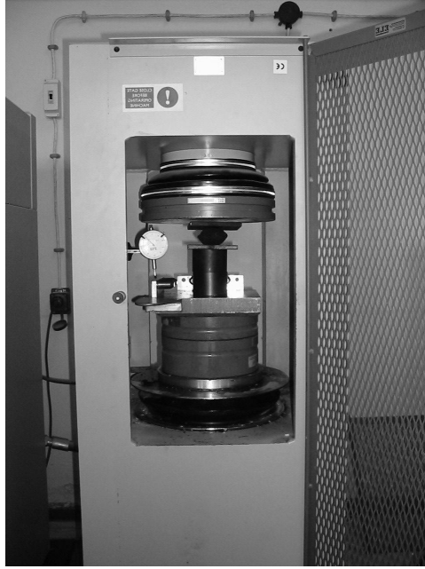
Şekil 4.33. Tek Eksenli Basma Dayanımı Deney Düzenegi.
