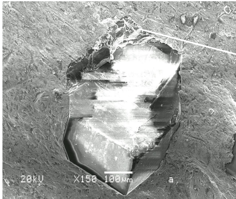
Şekil 8.6. Andezit Testeresi İçin Elmas Tanelerinin Yüzeyinde ve Üst Kısımındaki Aşınma
