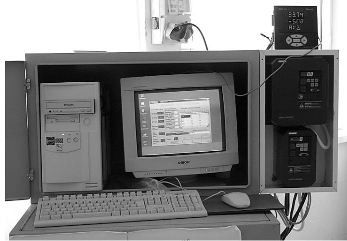
Şekil 4.3. Kesme Düzeneğini Kontrol Eden Bilgisayar Sistemi ve Hız Invertörleri.
