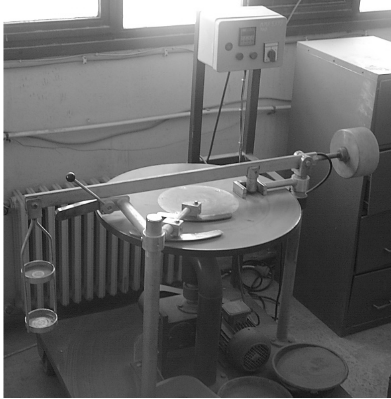
Şekil 4.51. Böhme Yüzeysel Aşınma Deney Düzeneği.
