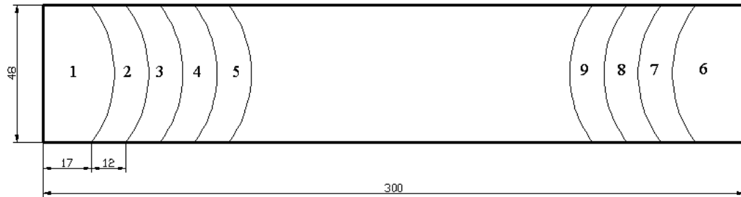
Şekil 4.2. Yüzey pürüzlülük deneyi yapılan iş parçası
