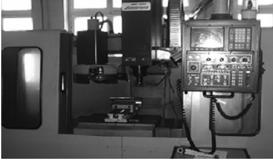
Resim 4.2. Johnford VMC-550 CNC dik işleme merkezi
