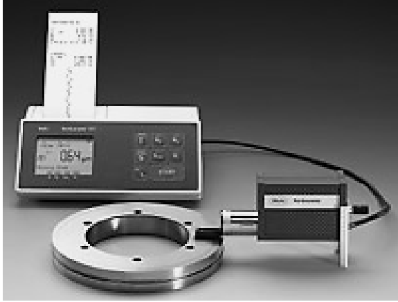
Resim 4.4. MAHR- Perthometer M1 taşınabilir yüzey pürüzlülük cihazı
