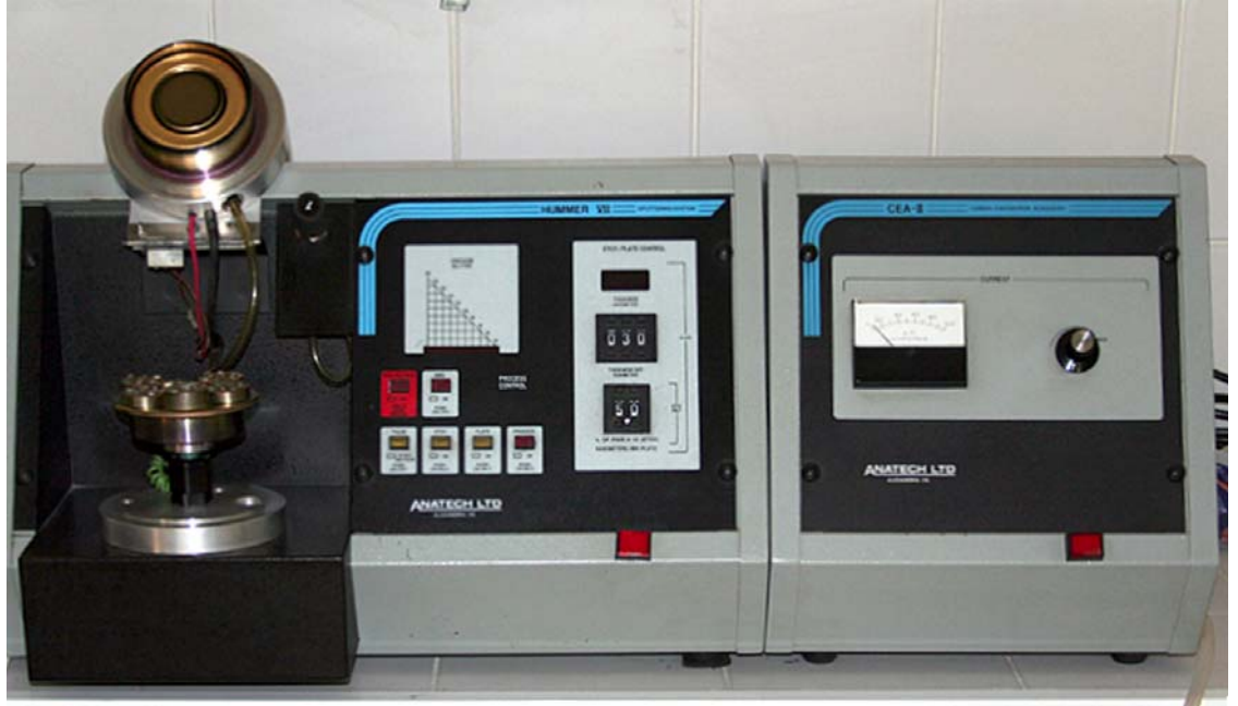
Resim 3-7 Altın-palladyum kaplama cihazı ve kaplanmış örneklerin cihaz içindeki konumu.
