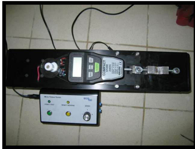
Resim 3–6 Mikro Gerilim Aleti
