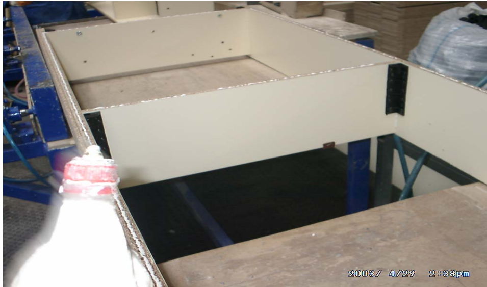
Şekil 4.2. Kasa Ayırıklarını Tutkallama İşlemi
