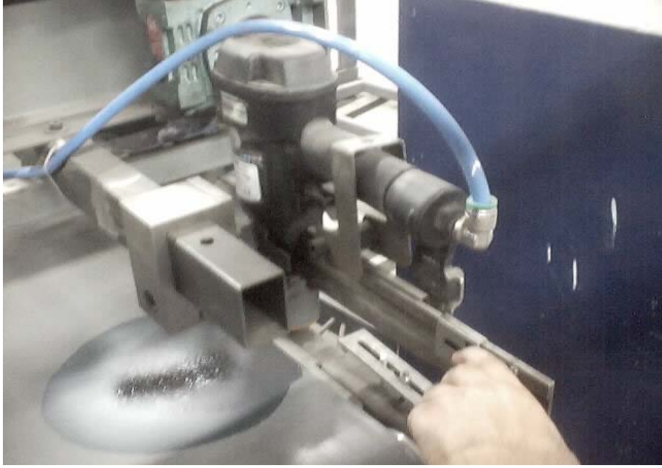
Şekil 5.4.5. Sisteme Adapte Edilmiş Stanley ATRO Vulcano 100/50 Tel Zimba Tabancasına Tel Doldurma İşlemi
