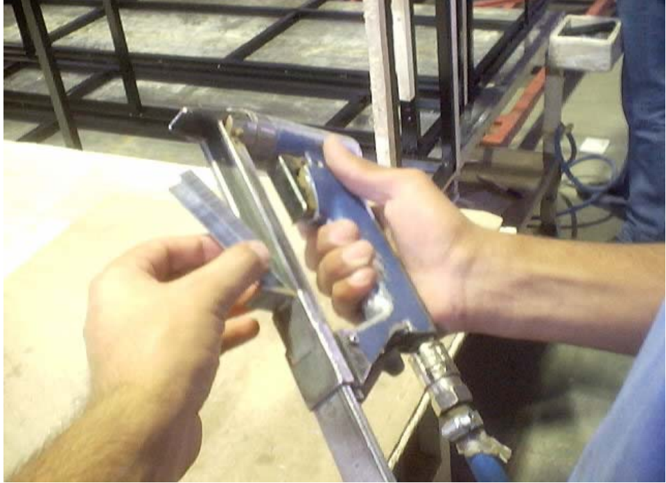
Şekil 5.4.2. Tel Zımba Tabancasının Doldurma İşlemi
