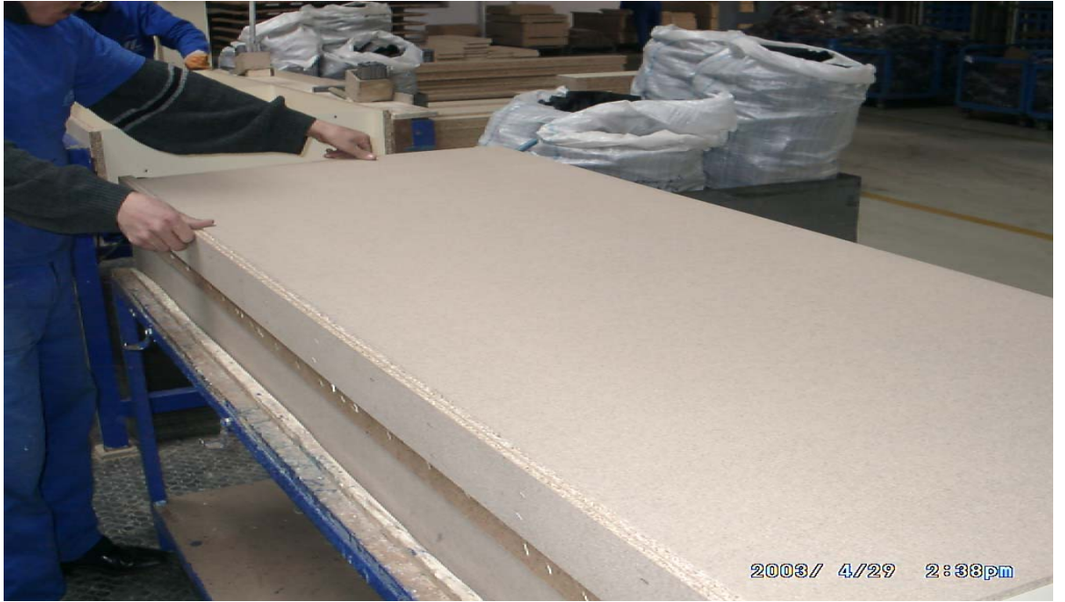
Şekil 4.3. Alt Sunta Koyma İşlemi
