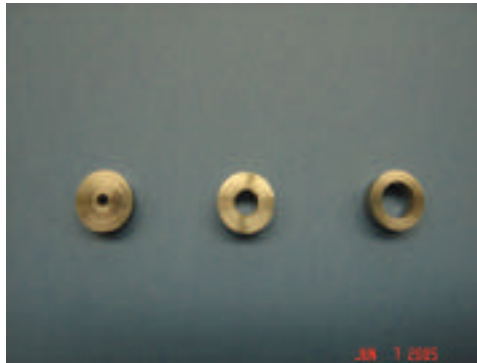
Şekil 14-15. 2mm, 4mm ve 6 mm iç çapındaki standart kalıplar
