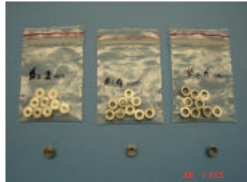
Şekil 14-15. 2mm, 4mm ve 6 mm iç çapındaki standart kalıplar
