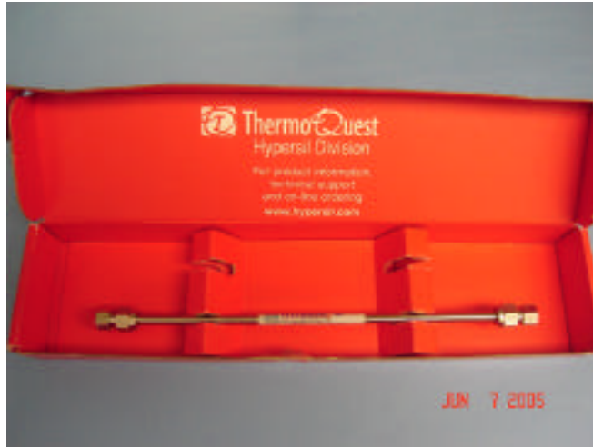
Şekil 20. Reverse faz analitik kolon C18 (250 x 4 mm 5 \mu Hypersil PEP 300, Thermo Quest, USA)
