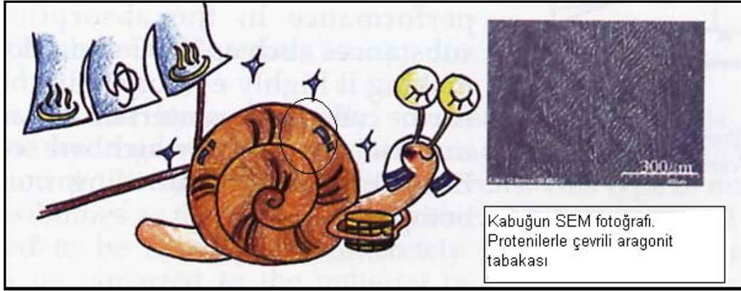
Şekil 3.10. Salyangoz kabuğuna ait mikroyapı görüntüsü, [23]
