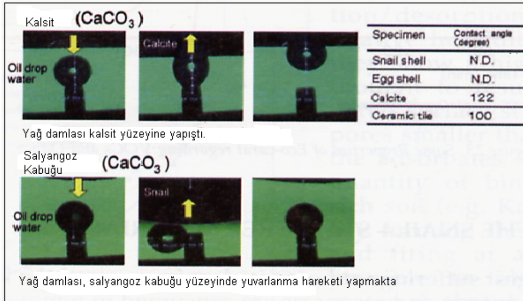
Şekil 3.11. Su içinde yağ damlası temas açısının ölçümü [23]
