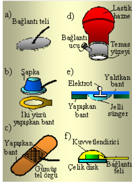
Şekil 2.8. Yüzey elektrodları a) metal plaka, b) gezici tipten c) bükülebilir d) emici düzenli, e) tümüyle atılabilir ve f) kuru elektrodlar
