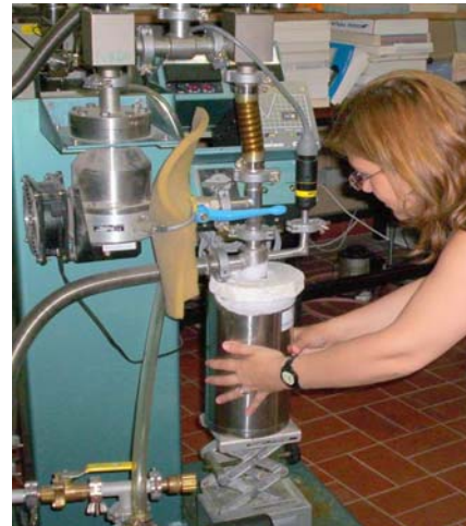
Şekil 7.2. Soğutucu gazın pompalanması
