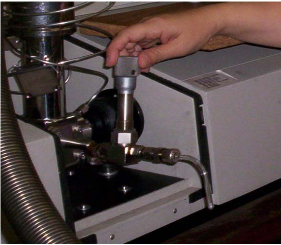
Şekil 7.1. Örneğin yerleştirildiği Knudsen hücresi
