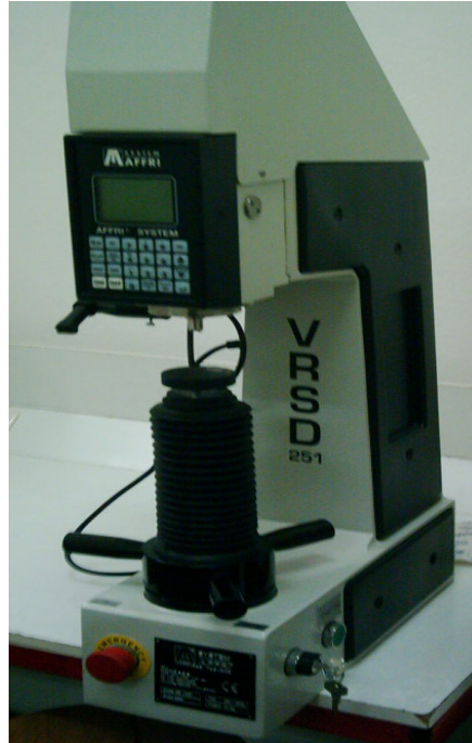
Şekil 7.2 Sertlik ölçüm cihazı.
