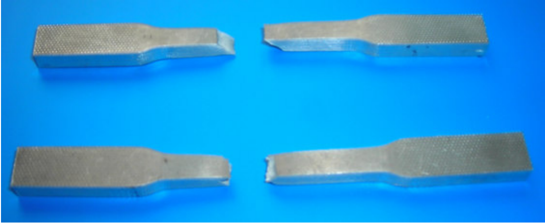
Şekil 7.7 Çekme deneyi sonucu numunede oluşan deformasyon.
