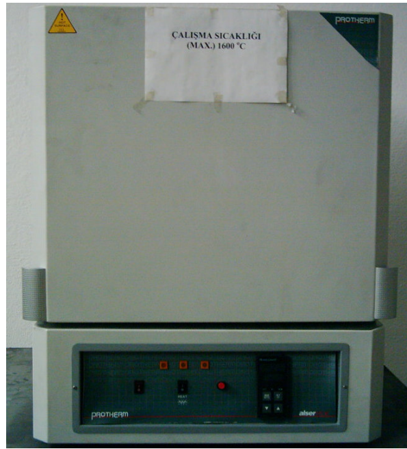
Şekil 7.1 Yaşlandırma işlemlerinin yapıldığı fırın.
