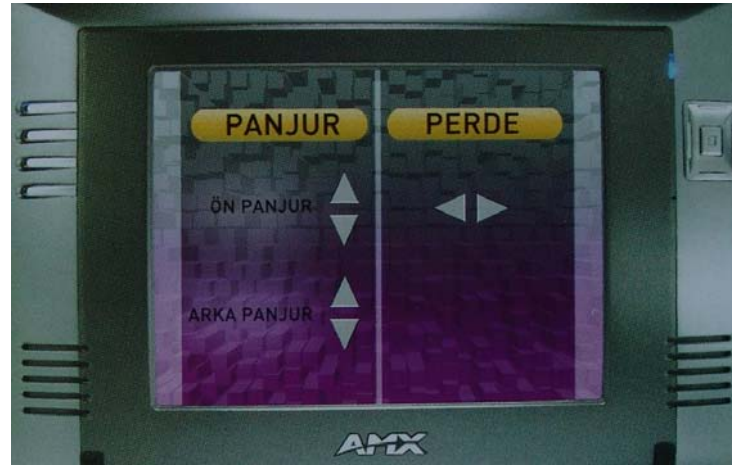
Resim 3. 23: Panjur- perde kontrolü seçilmiş touch panel
