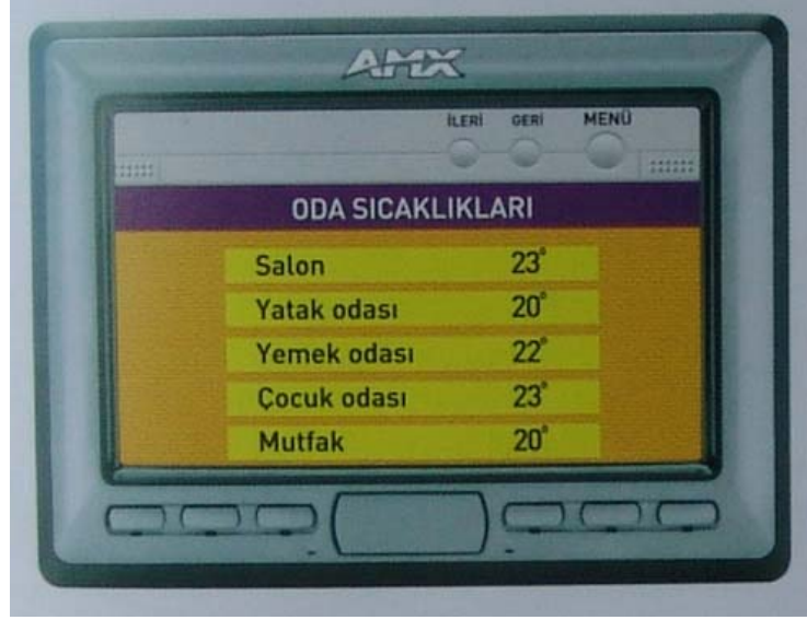
Resim 3.1: Oda sıcaklıklarının touch panelden izlenmesi.
