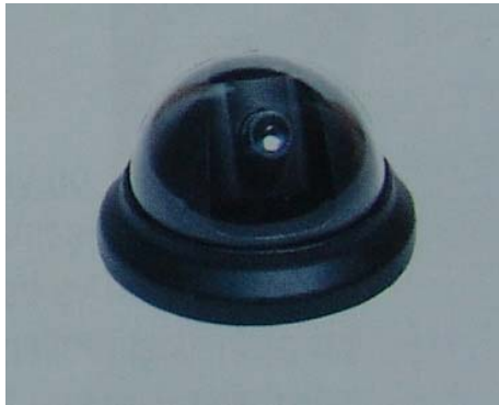
Resim 3.41: Tavan tipi Dome kamera, ve çok az ışıktaki görüntüleyen kamera.
