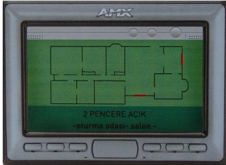
Resim 3.29: Plan üzerinden açık pencereleri gösteren touch panel
