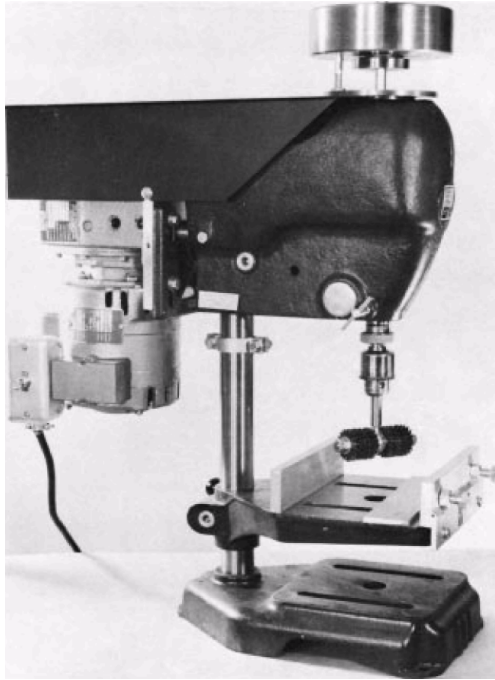
Resim 3.5. Aşındırma makinesi prensibi
